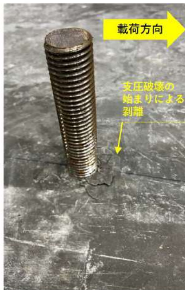
第 7-74 図 せん断試験後の状況写真（破壊形式確認ケース）
