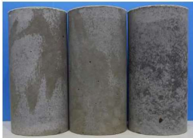
第 7-53 図 セメント改良土の室内試験用供試体 (φ150mm, H300mm)
