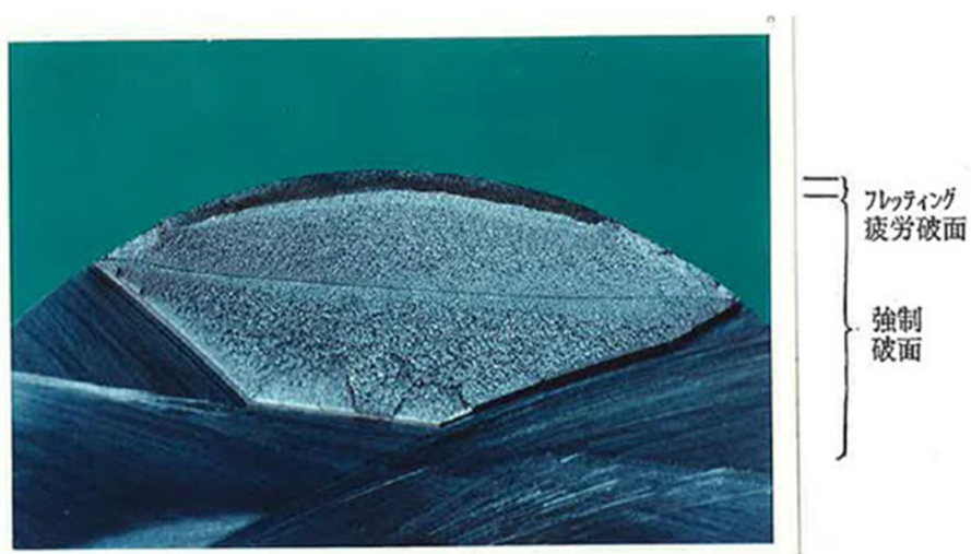
図7 フレット疲労破面例
