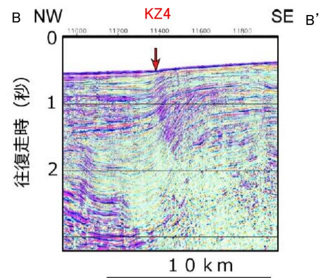
KZ4を横断する反射法地震探査時間マイグレーション断面(I2測線)
