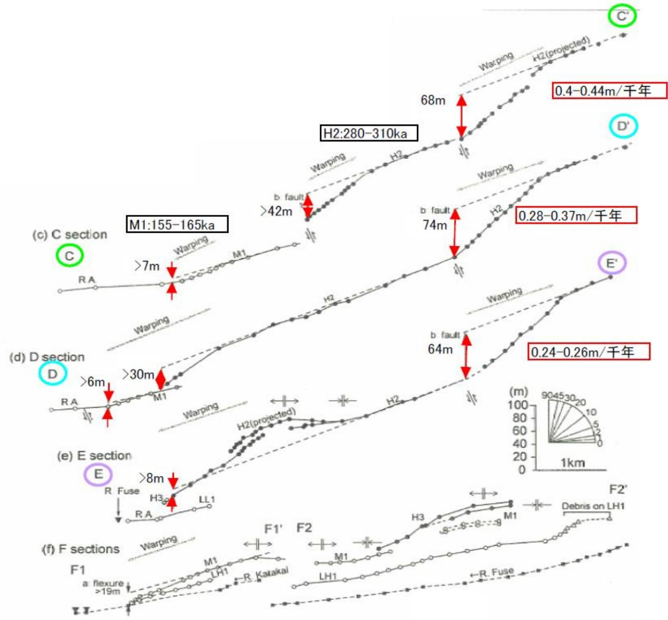
断面活動に伴う河成面の変形を示す断面図(地震調査委員会, 2007)
