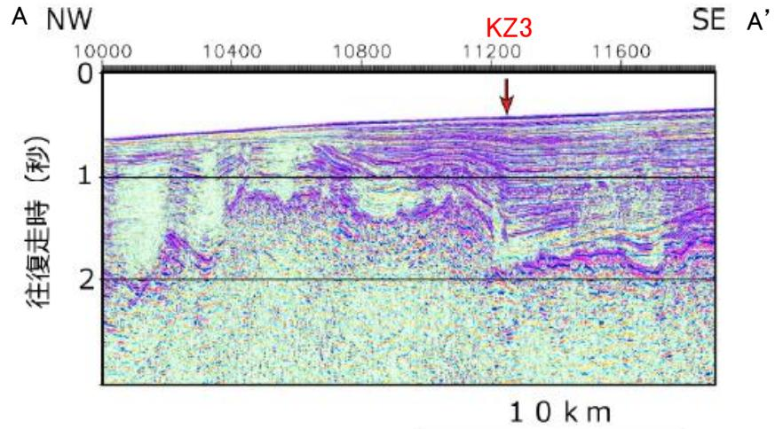
KZ3を横断する反射法地震探査時間マイグレーション断面(I3測線)
