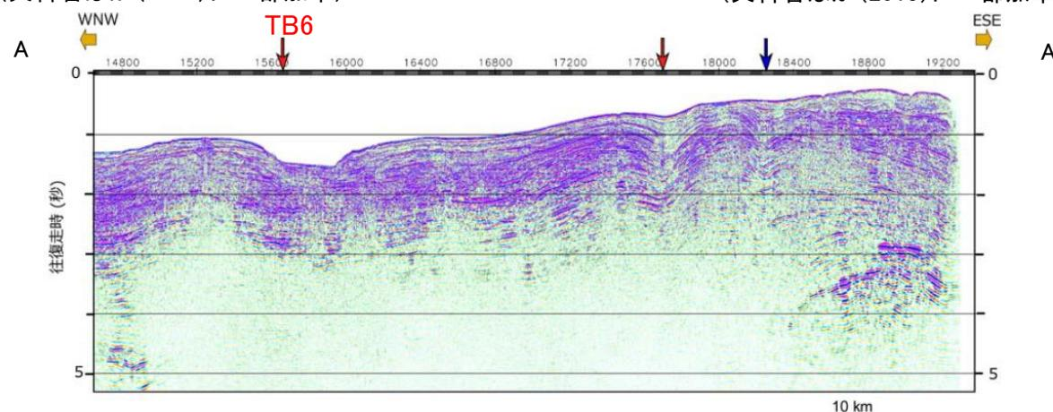
TB6を横断する反射法地震探査時間マイグレーション断面(T2測線)
