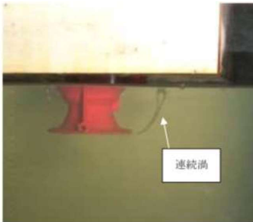
図 6 渦発生状況写真
