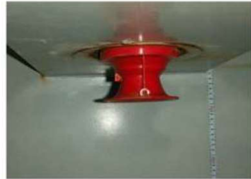
ポンプ部ベルマウス
