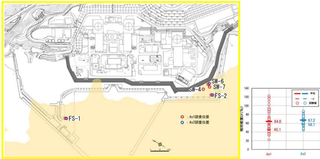
図 2. 1. c. b-4 砂層の相対密度調査位置図及び調査結果
