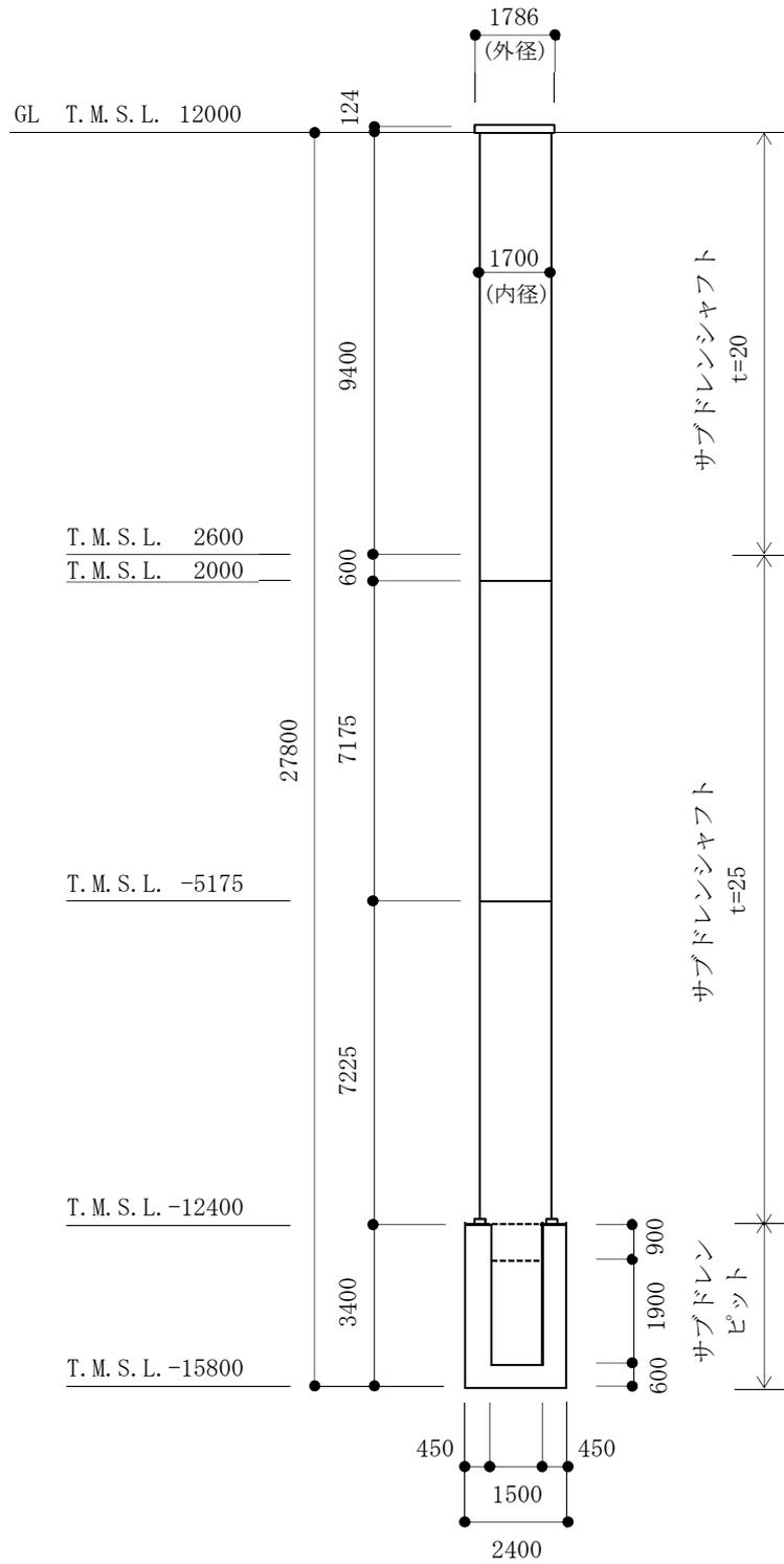
図 2-4 原子炉建屋サブドレンシヤフトの概略断面図 (単位 : mm)
