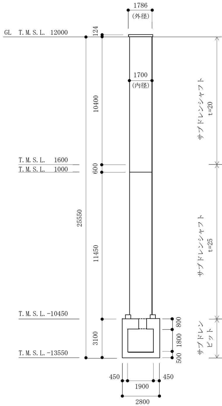
図 2-7 タービン建屋サブドレンシヤフトの概略断面図 (単位 : mm)
