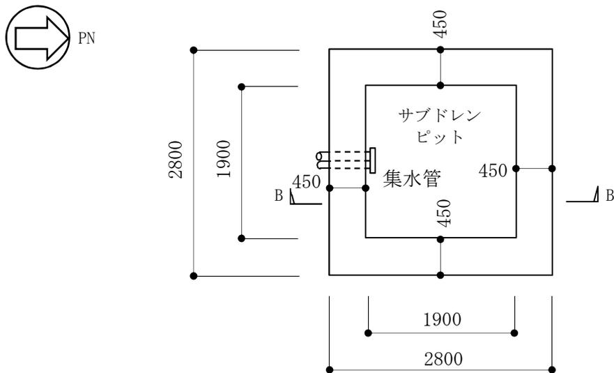
図 2-9 タービン建屋サブドレンピットの概略平面図 (T.M.S.L. -13.05m) (単位 : mm)
