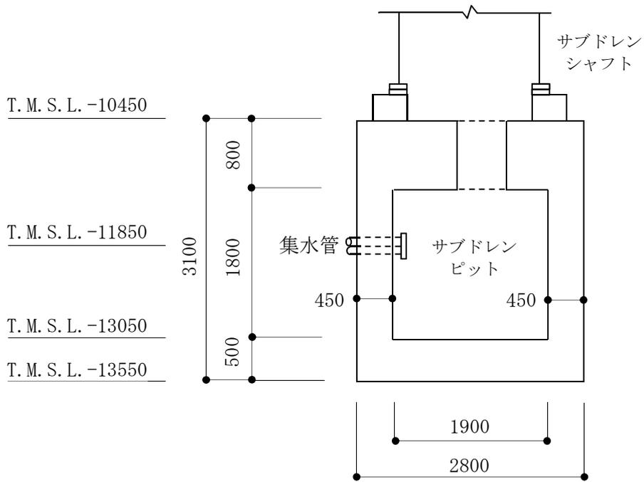
図 2-8 タービン建屋サブドレンピットの概略断面図 (B-B 断面) (単位 : mm)
