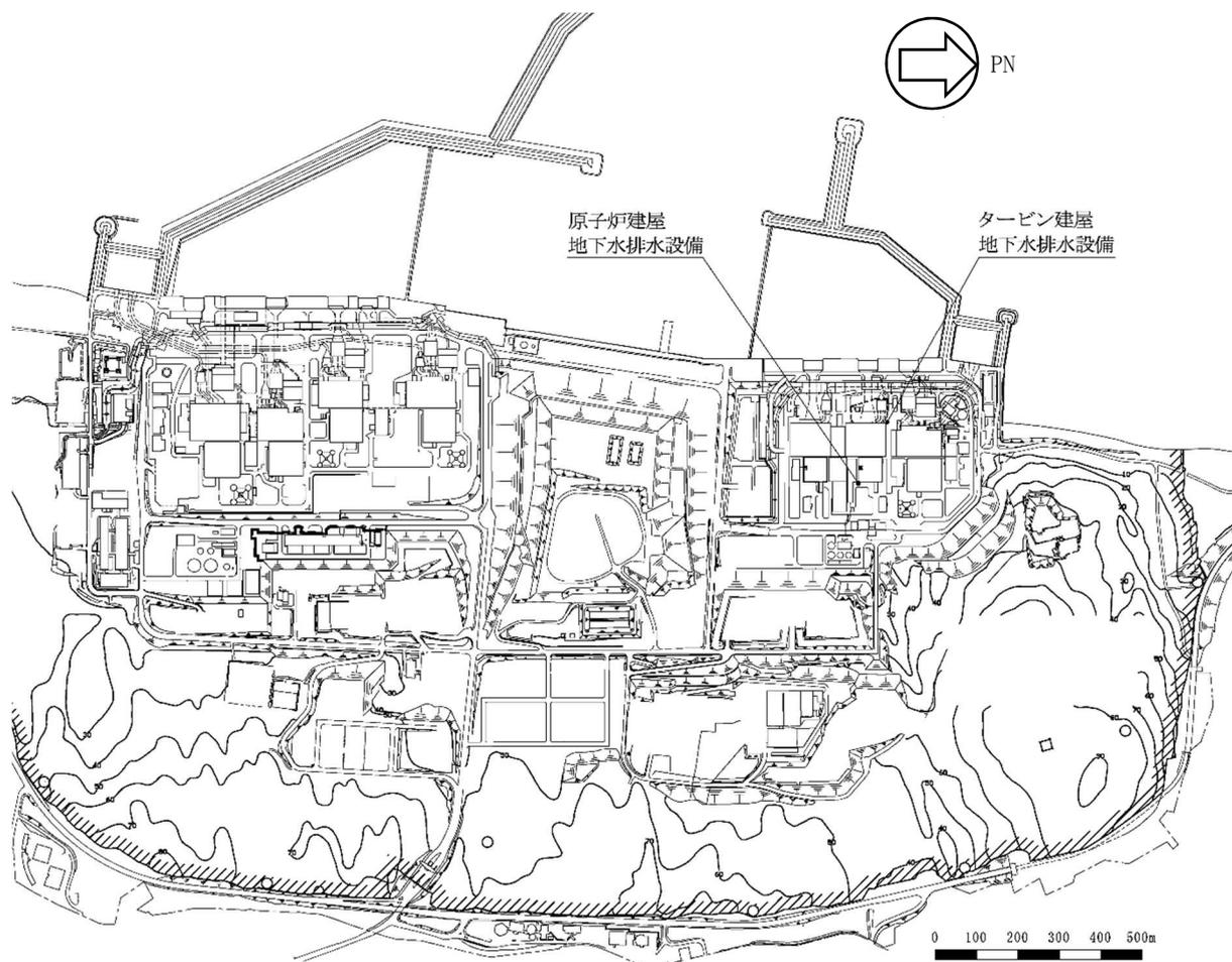
図 2-1 地下水排水設備の概略配置図
