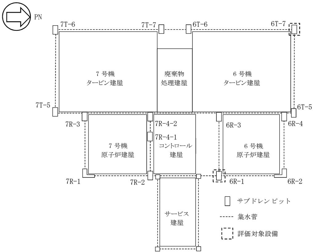
図 2-2 地下水排水設備の評価対象配置図
