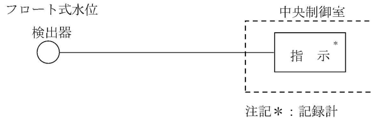
図13 ドレンタンク水位の概略構成図
