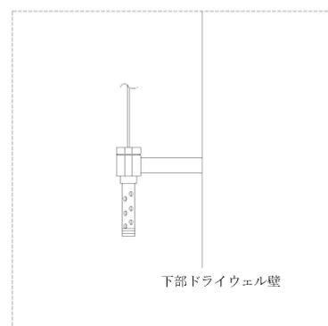
図2-3 格納容器下部水位計取付図
