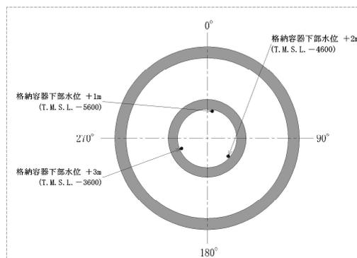
図2-2 格納容器下部水位計配置図
