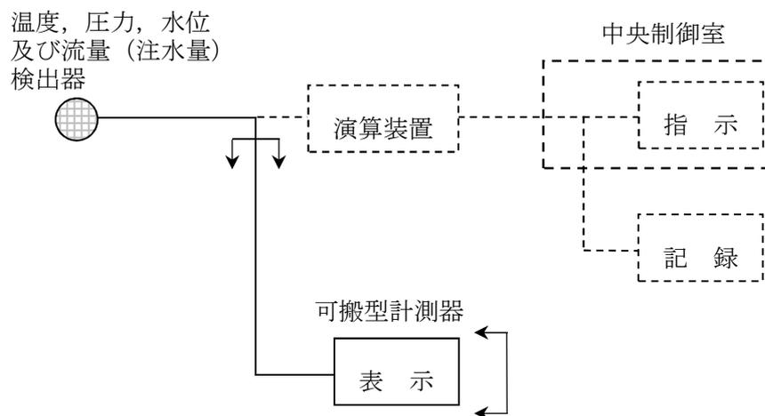
図 4-1 可搬型計測器の概略構成図
