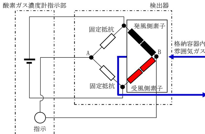
図1-2 酸素濃度計検出回路の概要図
