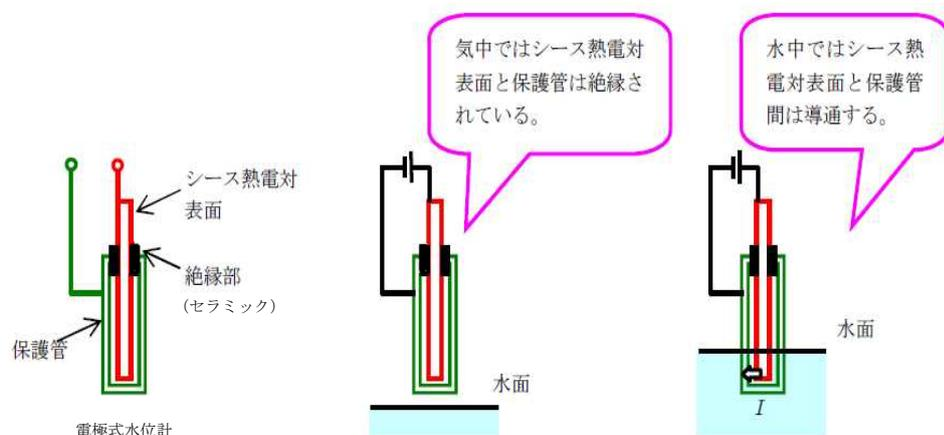
図 2-4 電極式水位計の動作原理
