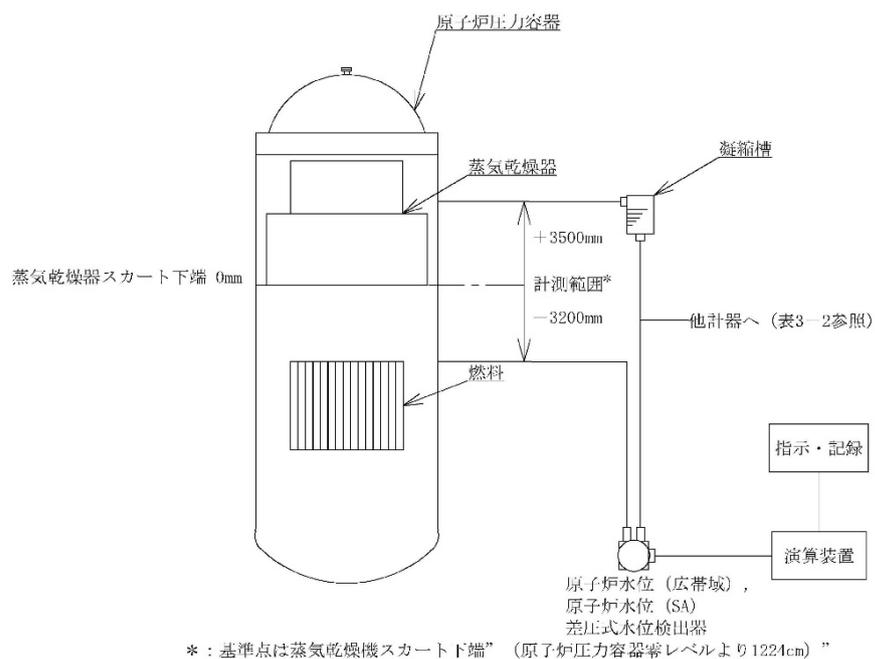
図 3-1 原子炉水位 (広帯域) 及び原子炉水位 (SA) の概要
