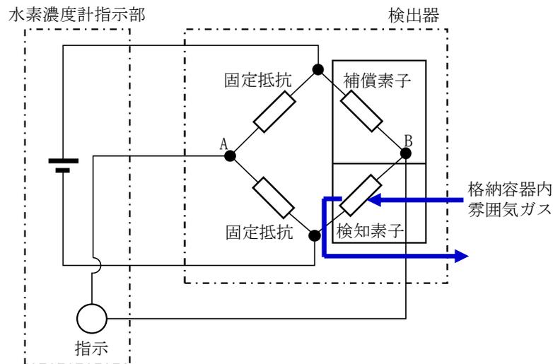
図1-1 水素濃度計検出回路の概要図
