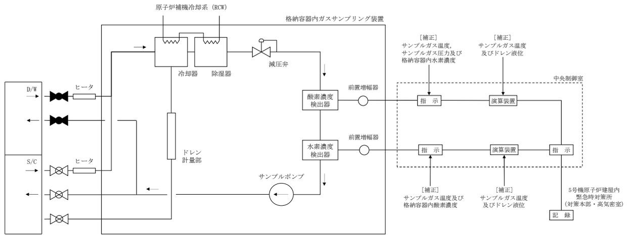
図 1-4 格納容器内ガスサンプリング装置の構成
