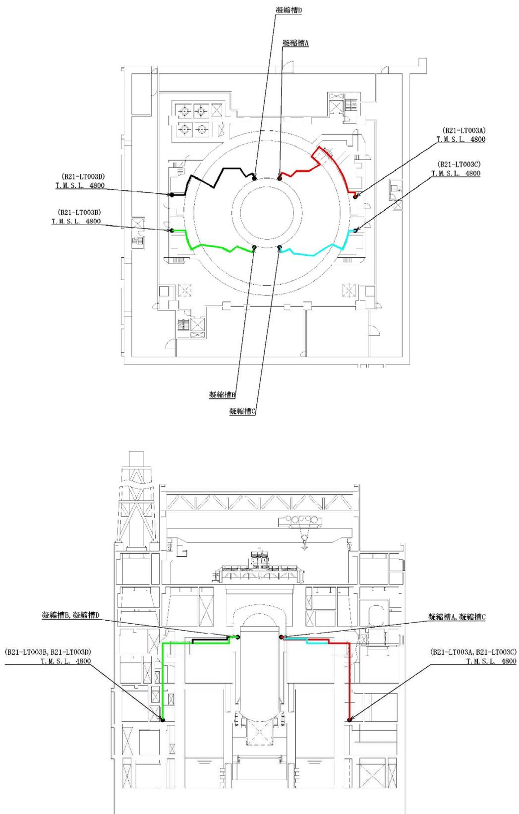
図 3-5 凝縮槽から原子炉水位への配管ルート概略図
