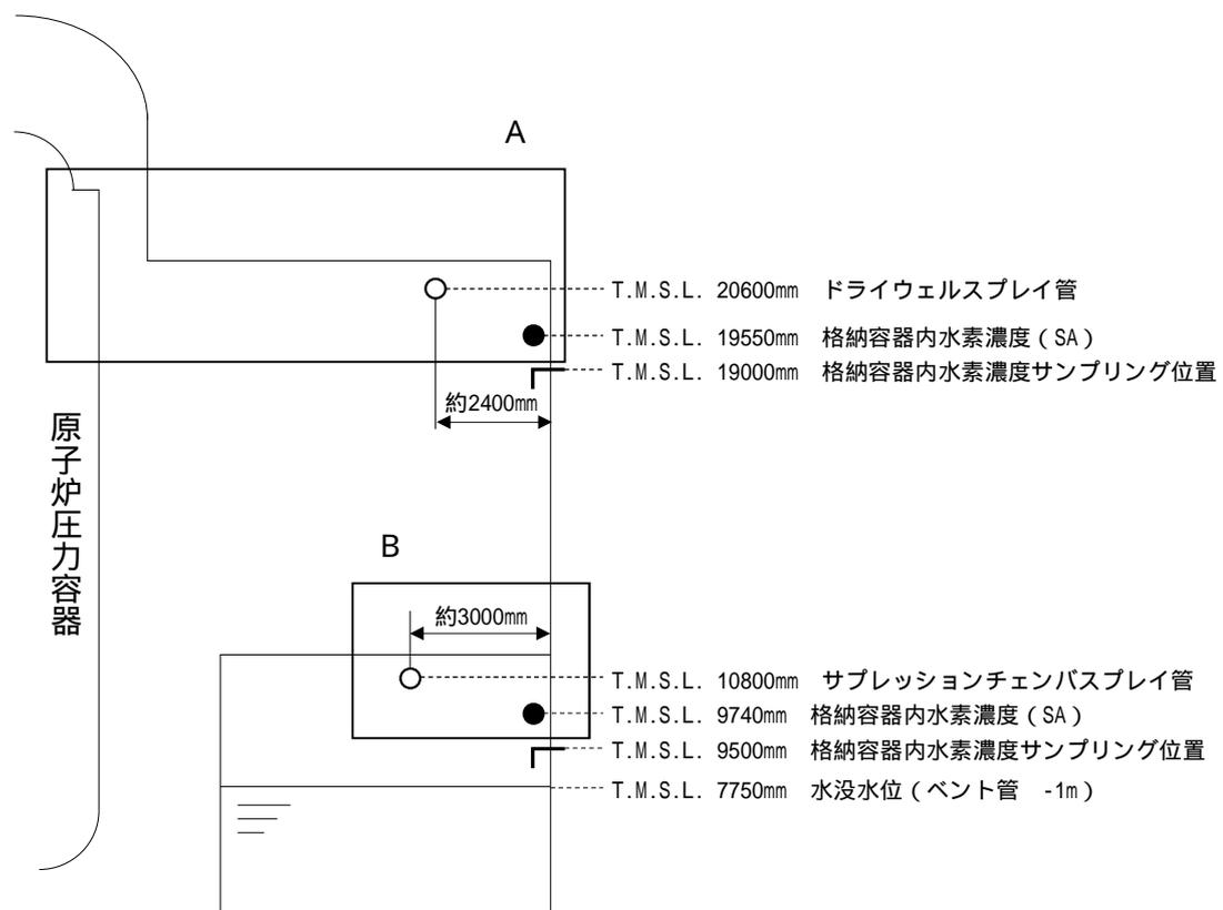
図 1-1 格納容器内水素濃度（SA）の設置位置
