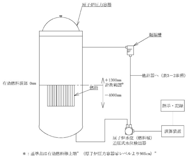
図 3-2 原子炉水位 (燃料域) の概要
