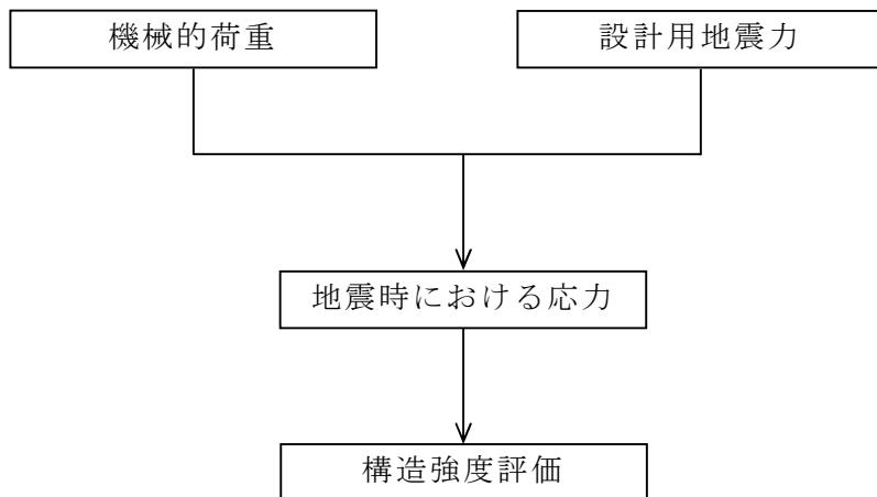
図2-1 炉心支持構造物の耐震評価フロー
