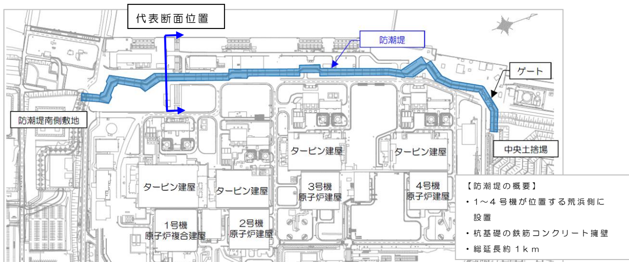
図 1.2-26(1) 荒浜側防潮堤の概要
