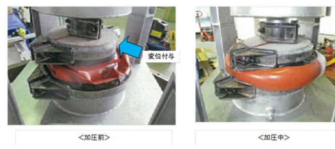
図4-5 漏えい試験概要図 (ブーツ)
