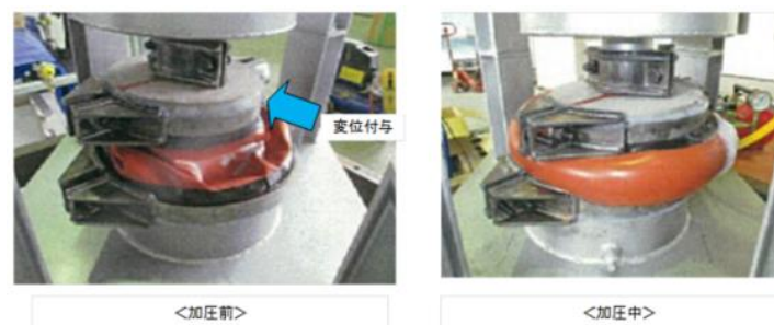
図4-5 漏えい試験概要図 (ブーツ)
