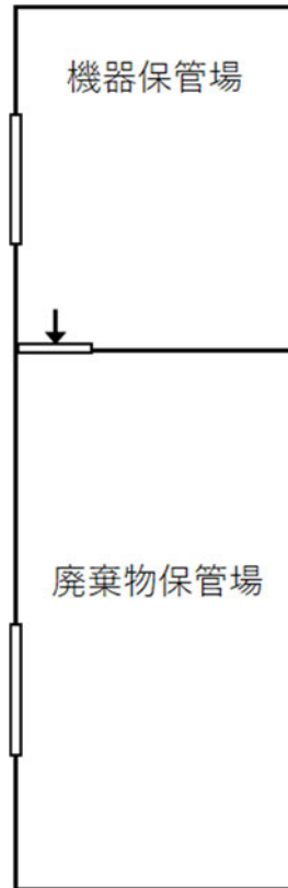
添付図 4. 1. 2. 1-2 廃棄物保管場と機器保管場を区画する鋼製柵（矢印）
