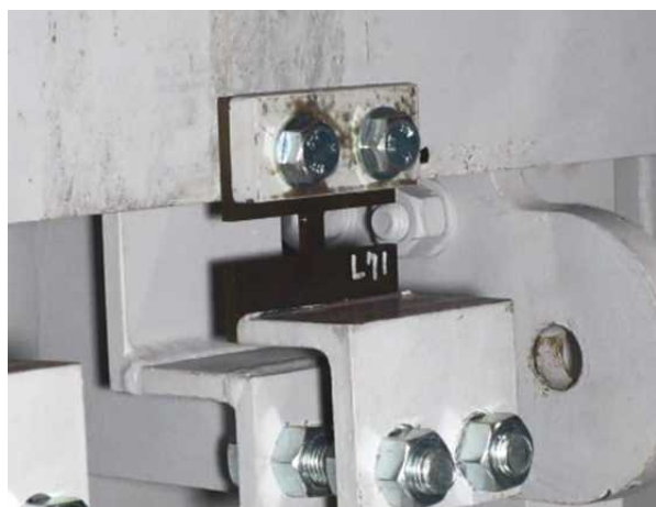
図 2-1 止板の固定状態及び開放後の状態
