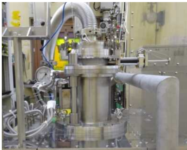
ペレット加熱試験装置の外観 8
