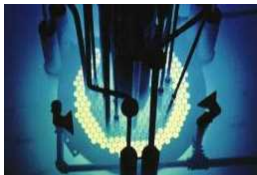
試験炉を用いた RIA模擬試験の様子 7
