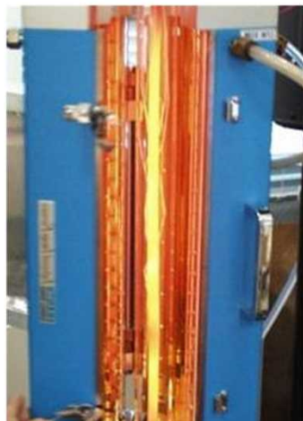
被覆管炉外高温試験の様子 7
