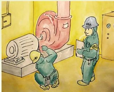
・現場巡視、点検等により、弁の開閉状況から系統構成が適切な状態であるか、弁、ポンプ等の機器から、漏えい、異音等の異常がないかを観察。
