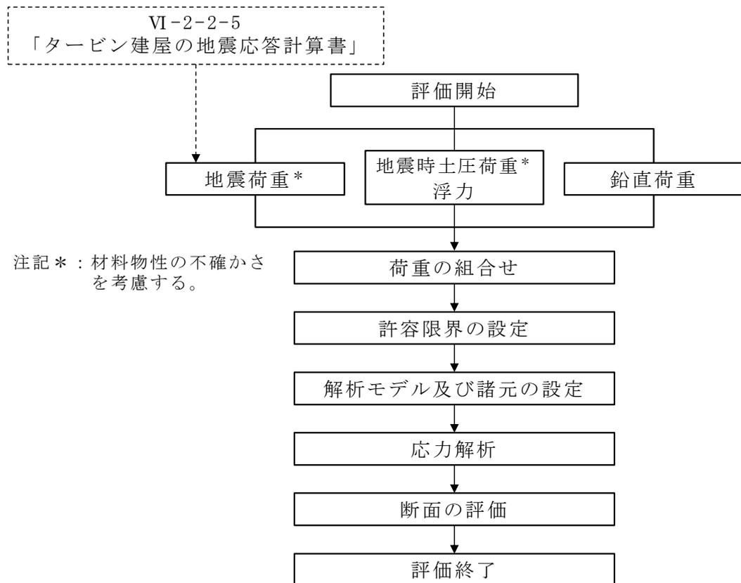
図 4-1 応力解析による評価フロー
