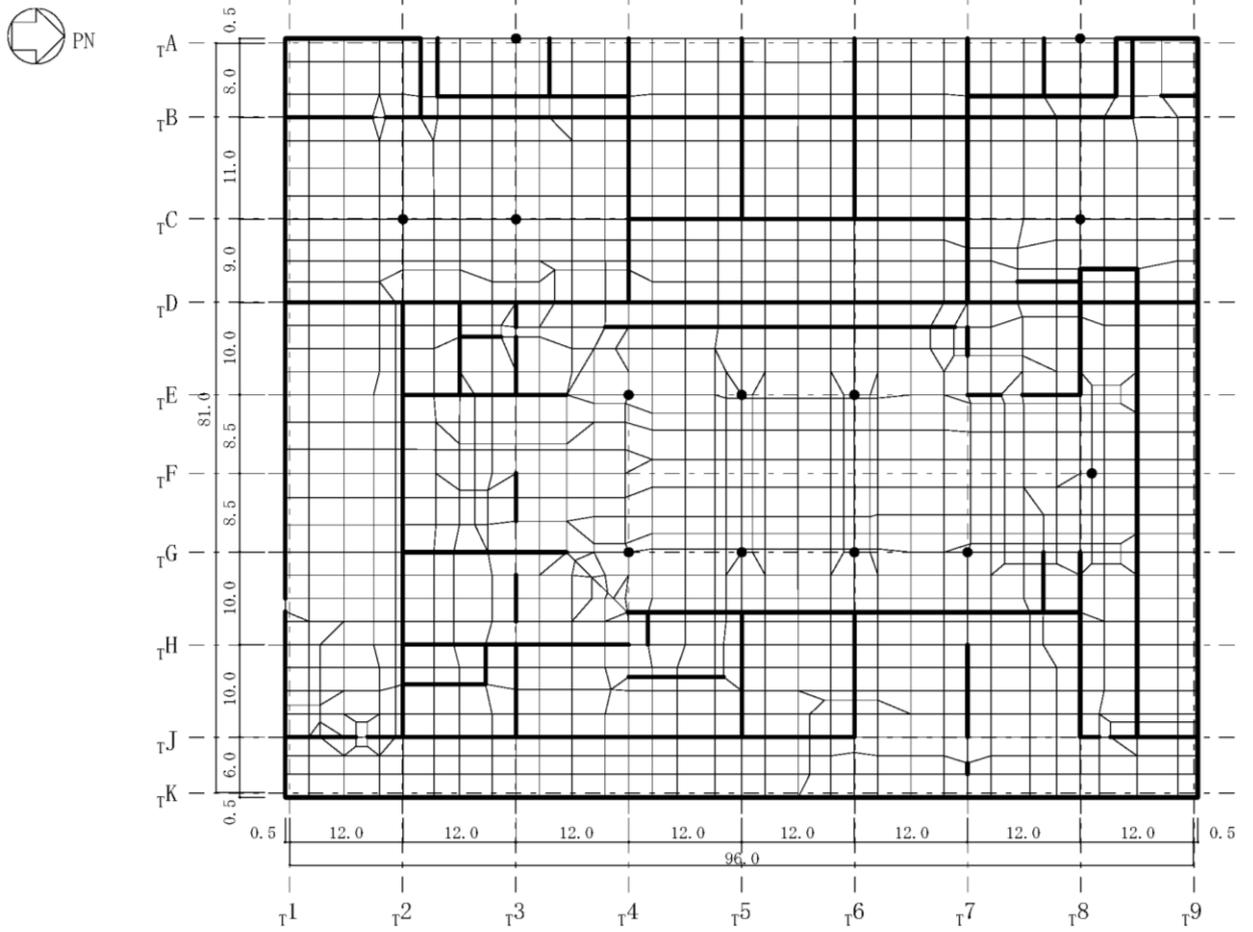
注：太線部は耐震壁及び補助壁，黒丸は独立柱の位置を示す。
