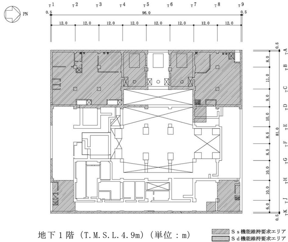
図 2-5 基準地震動 S s 及び弾性設計用地震動 S d に対する機能維持要求エリア (1/2)
