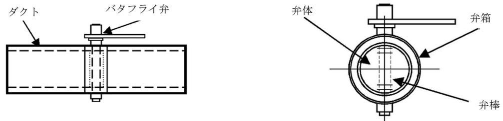
図2-5 バタフライ弁の概要図
