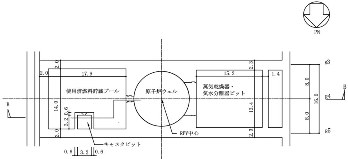
図 2-4 使用済燃料貯蔵プール及びキャスクピット周りの概略平面図 (単位 : m)
