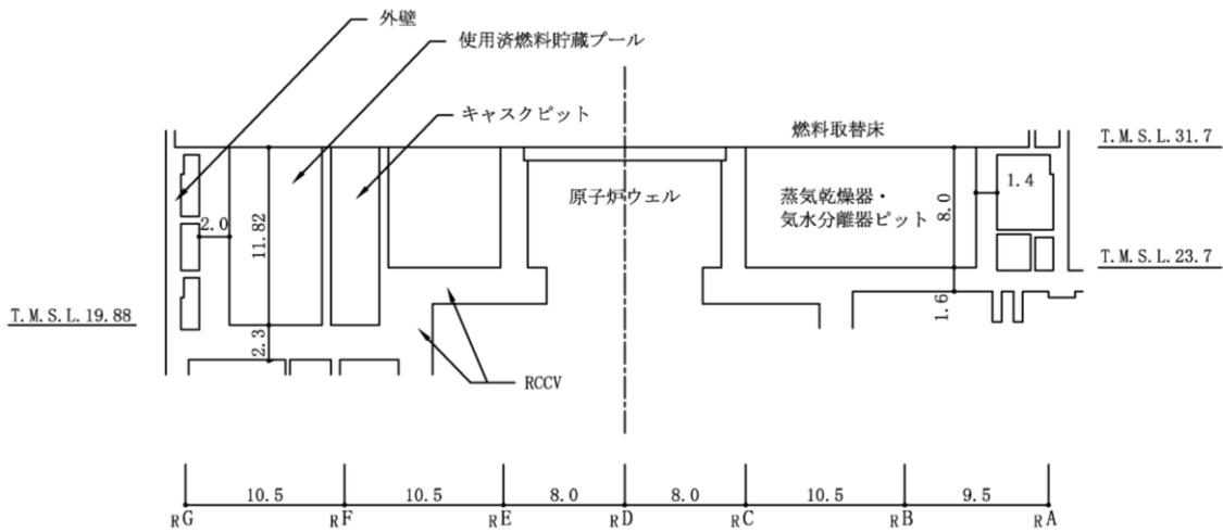
図 2-5 使用済燃料貯蔵プール及びキャスクピット周りの概略断面図 (B-B 断面) (単位 : m)
