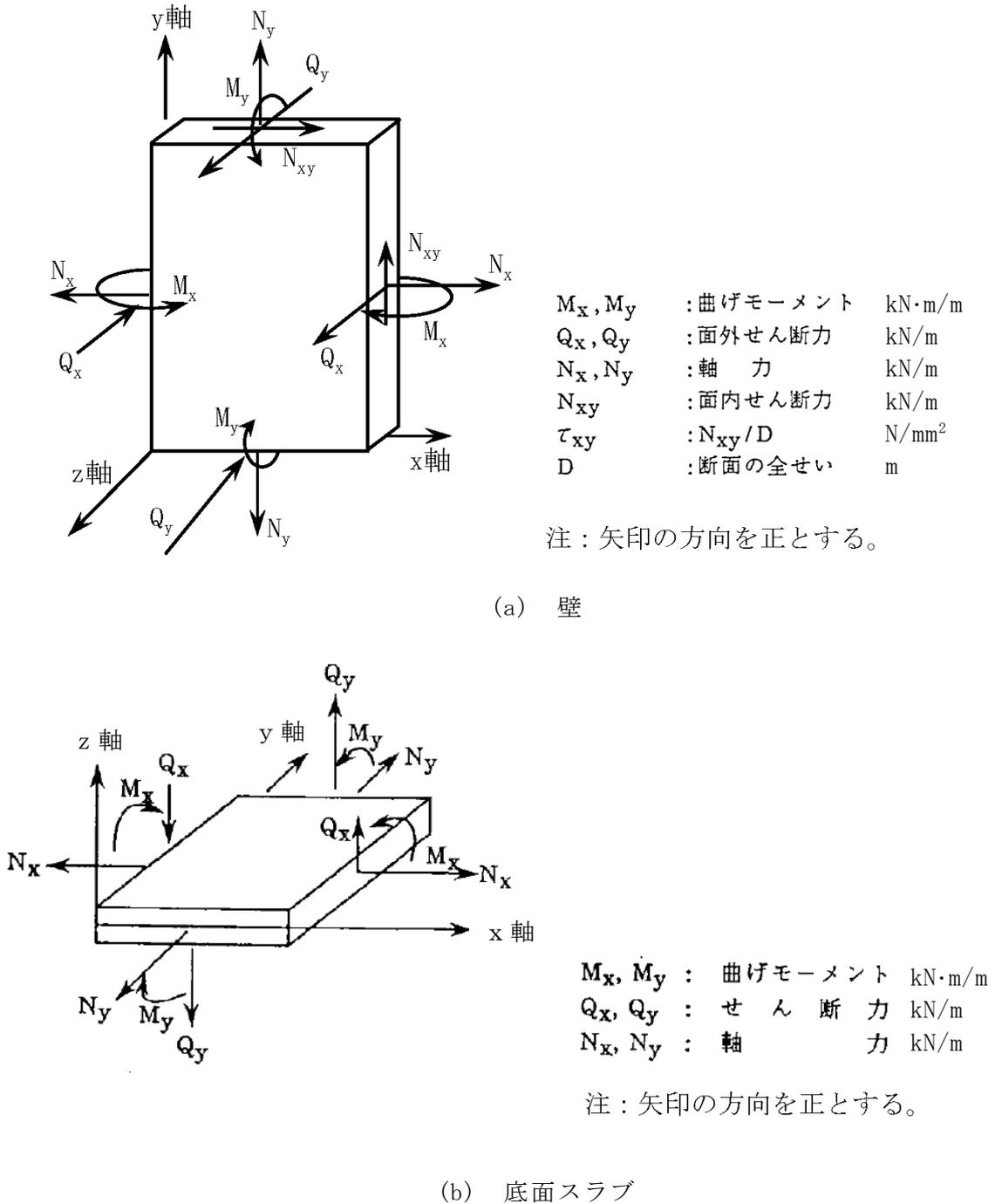
図 3-4 壁及び底面スラブの断面力成分
