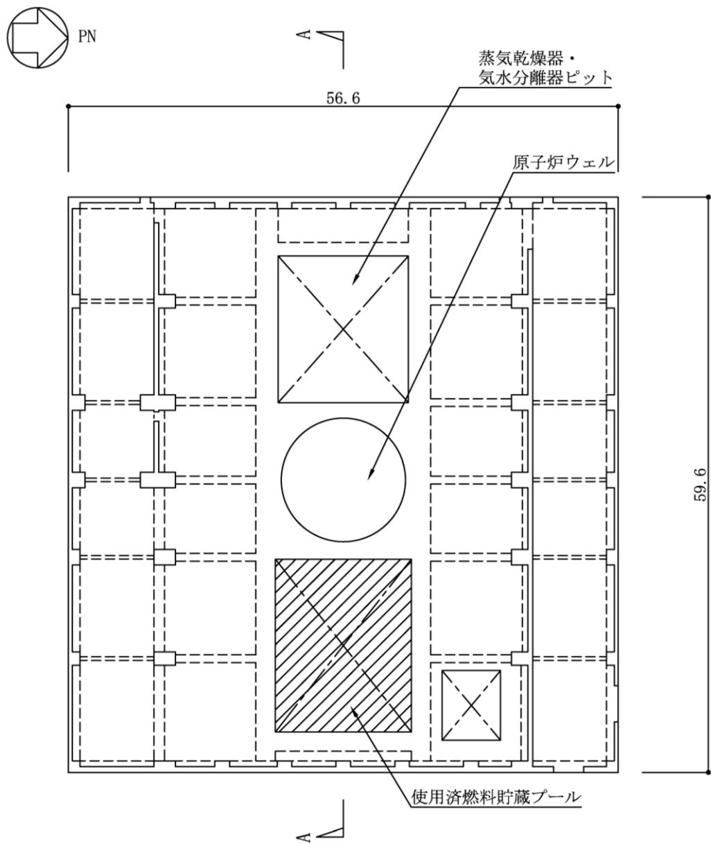
図 2-2 使用済燃料貯蔵プール及びキャスクピットを含む原子炉建屋の概略平面図
