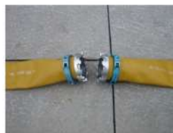
可搬型ホース（150A）接続前
