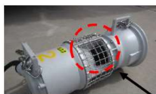
①水中ポンプの吸込み部
