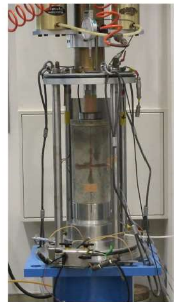
一軸圧縮試験の状況
