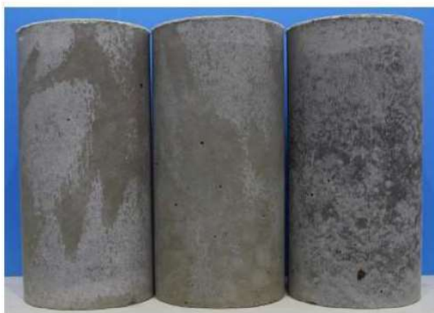
第 7-46 図 セメント改良土の室内試験用供試体 ( \phi 150\text{mm} , H300mm)
