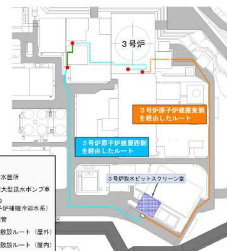
第5図 原子炉補機冷却水系への通水確保（海水）の概略図
