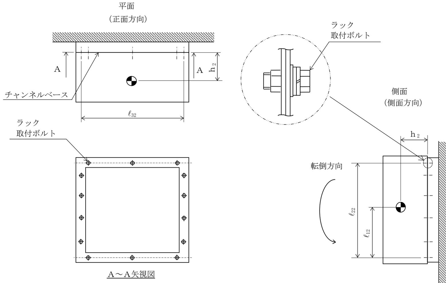
【高圧炉心注水系ポンプ吐出圧力（E22-PT006C）の耐震性についての計算結果】
