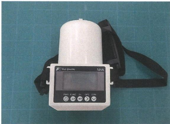
電離箱式サーベイメーターNHA1(富士電機製)
