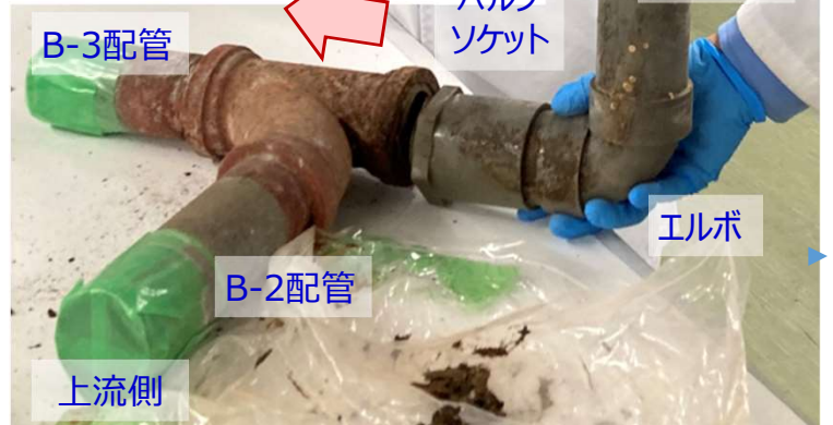
脱落配管B 脱落前状況 (上流側より観察したものを再現)
