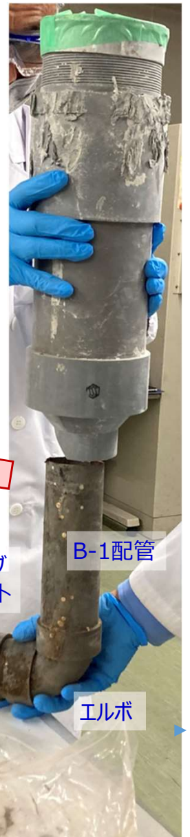
脱落配管B 脱落前状況 (上流側より観察したものを再現)
