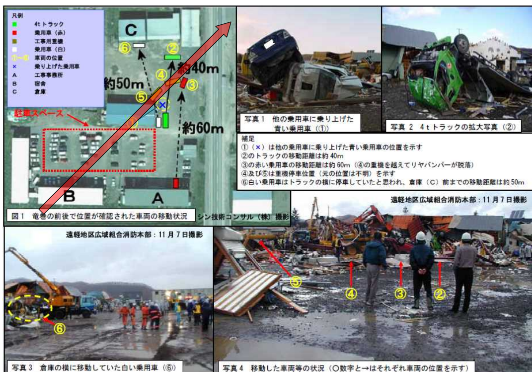
図30 佐呂間竜巻（2006.11.7）による被災状況（工事事務所敷地内の車両被災） (25)
