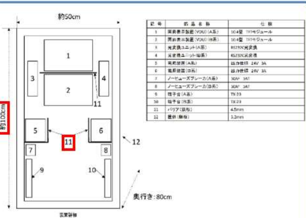
安全系 VDU 盤内の構成機器配置図
