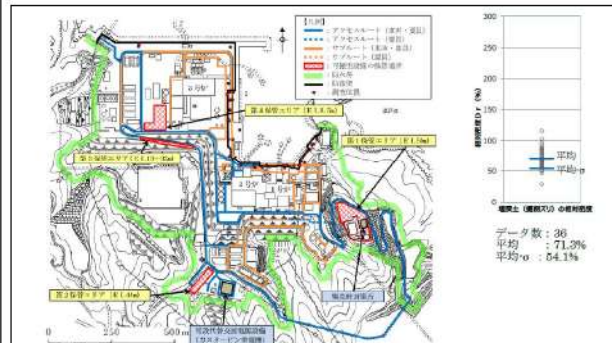
第3図 埋戻土 (掘削ズリ) の相対密度の調査位置及び調査結果
