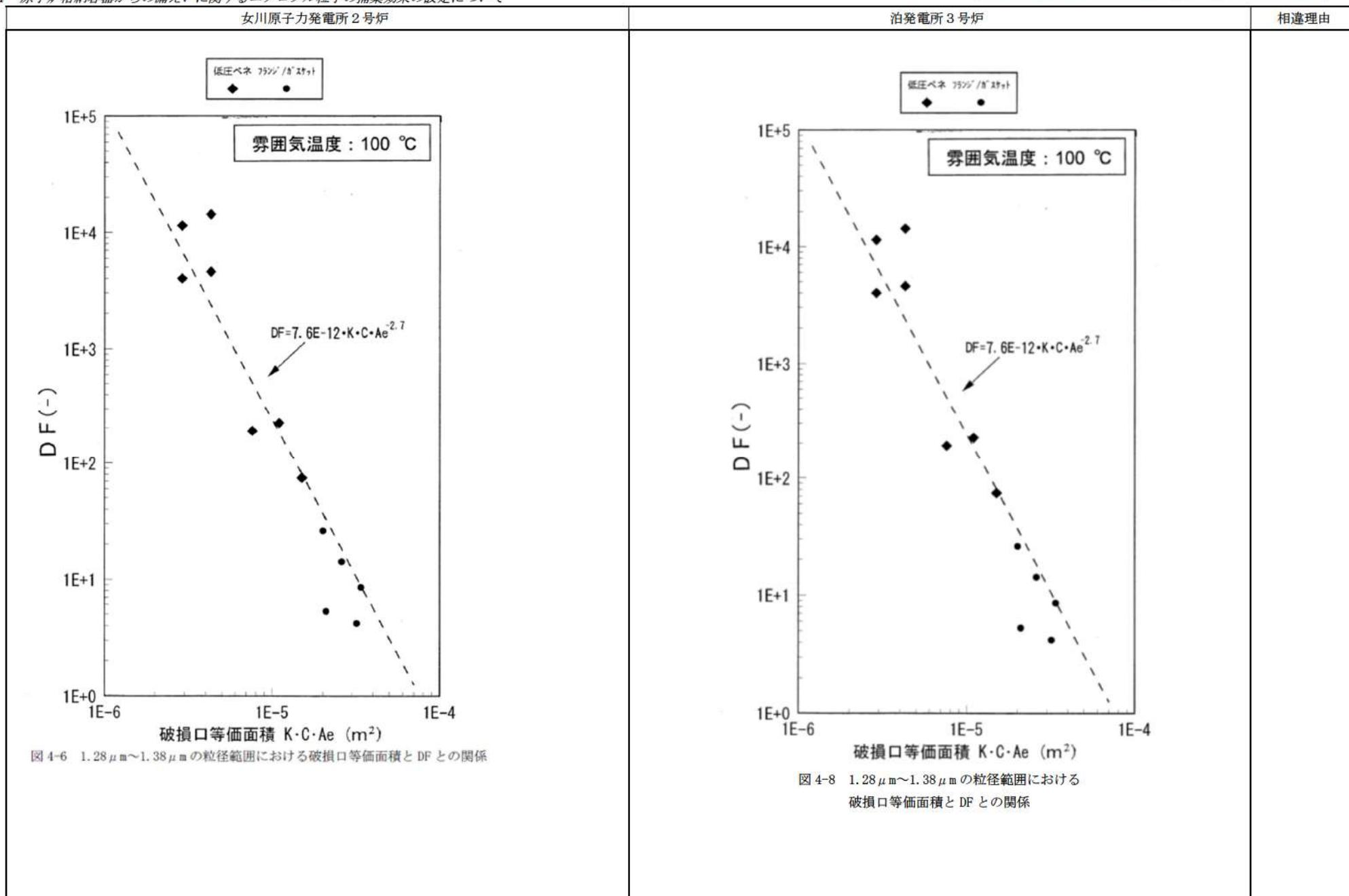
図4-6 1.28 μm～1.38 μmの粒径範囲における破損口等価面積とDFとの関係
