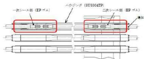
高電圧用モジュール（高電圧動力用）
