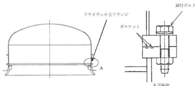
図 2-2 ドライウェル主フランジシール部概要図
