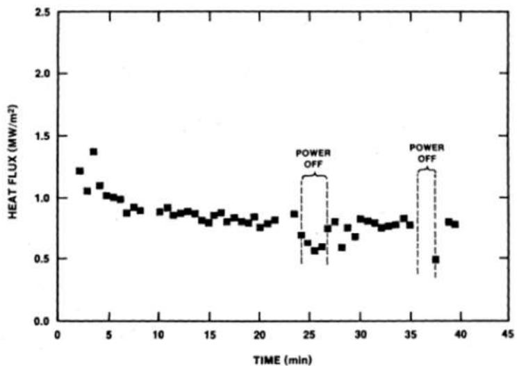
付図2-2 SWISS-2 実験の水プールへの熱流束<sup>[7]</sup>
