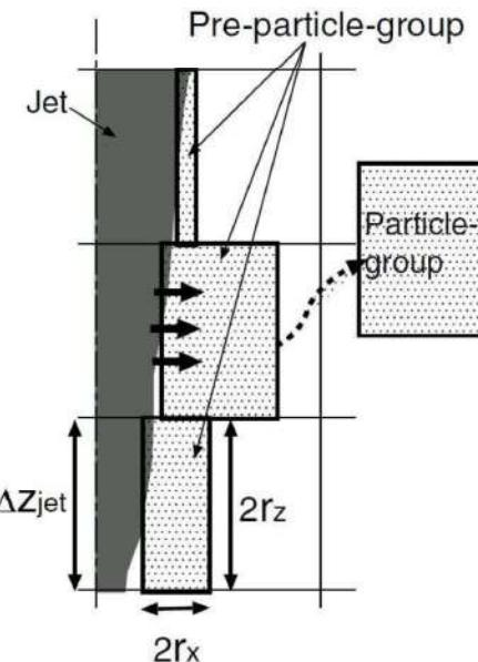
図2-6 融体粒子モデル概要図<sup>[1]</sup>
