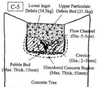
(実験後のコリウム断面の模式図)
