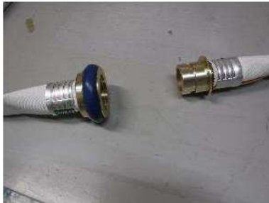
消防ホース (40A) 接続前
