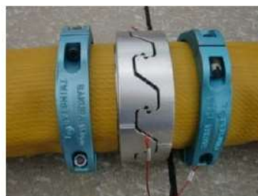
可搬型ホース（150A）接続後
