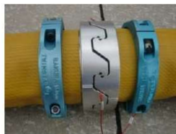
可搬型ホース（150A）接続後
