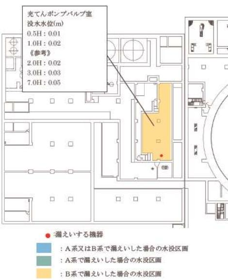
図3 濾水評価 (T.P. 10.3m 中間床)
