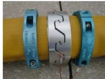
可搬型ホース（150A）接続後
