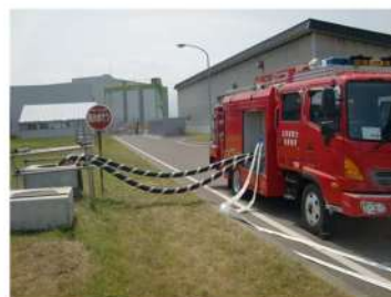
水源への吸管挿入 (屋外)
