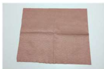
吸着布 （フッ素樹脂系類縁体を吸着剤として担持した布）
