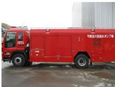
可搬型大型送水ポンプ車
