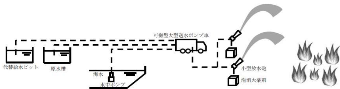
可搬型大型送水ポンプ車及び小型放水砲による泡消火
