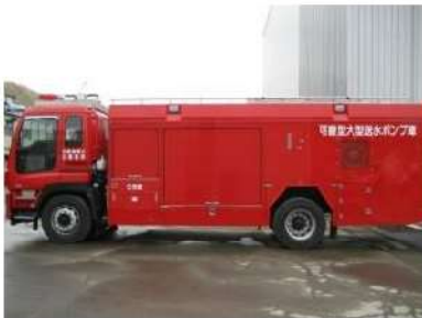
可搬型大型送水ポンプ車
