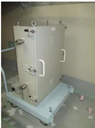
可搬型アニュラス水素濃度計測ユニット (周辺補機棟 T. P. 24. 8m)
