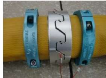
可搬型ホース(150A)接続後
