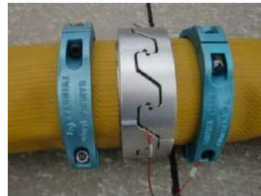
可搬型ホース（150A）接続後
