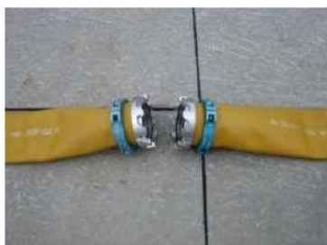
可搬型ホース(150A)接続前
