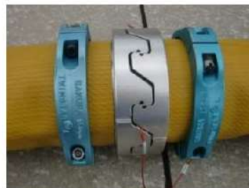
可搬型ホース(150A)接続後
