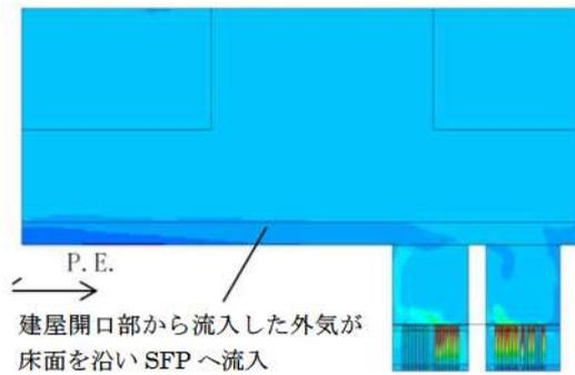
建屋の縦断面 (SFP 中央断面)
