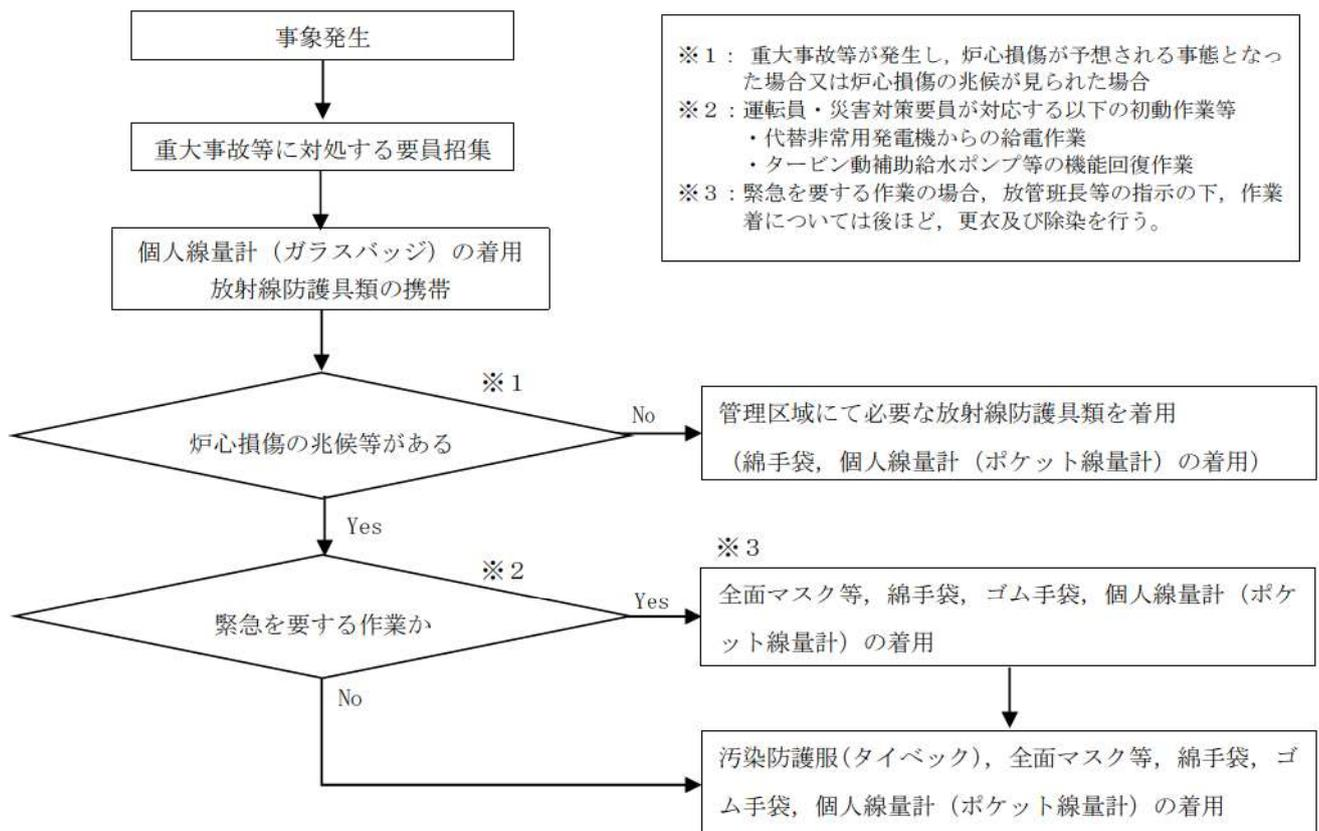
図1 放射線防護具類の選定方法
