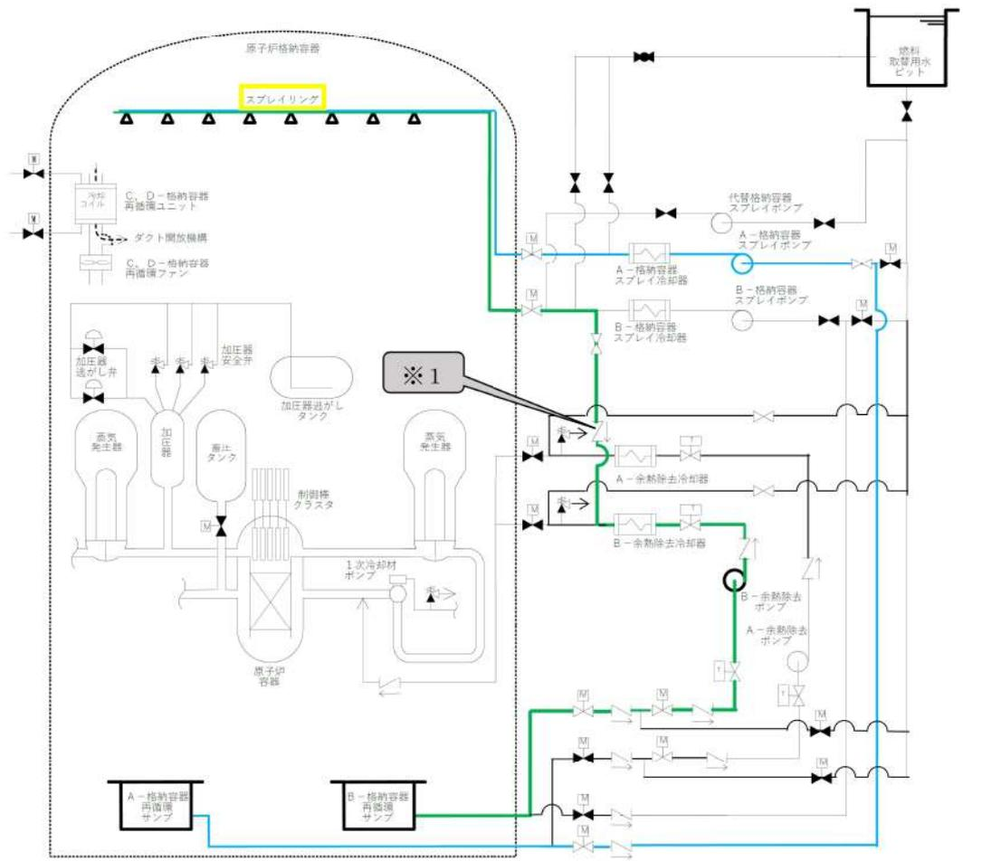
※1 逆止弁の弁体を撤去する。
