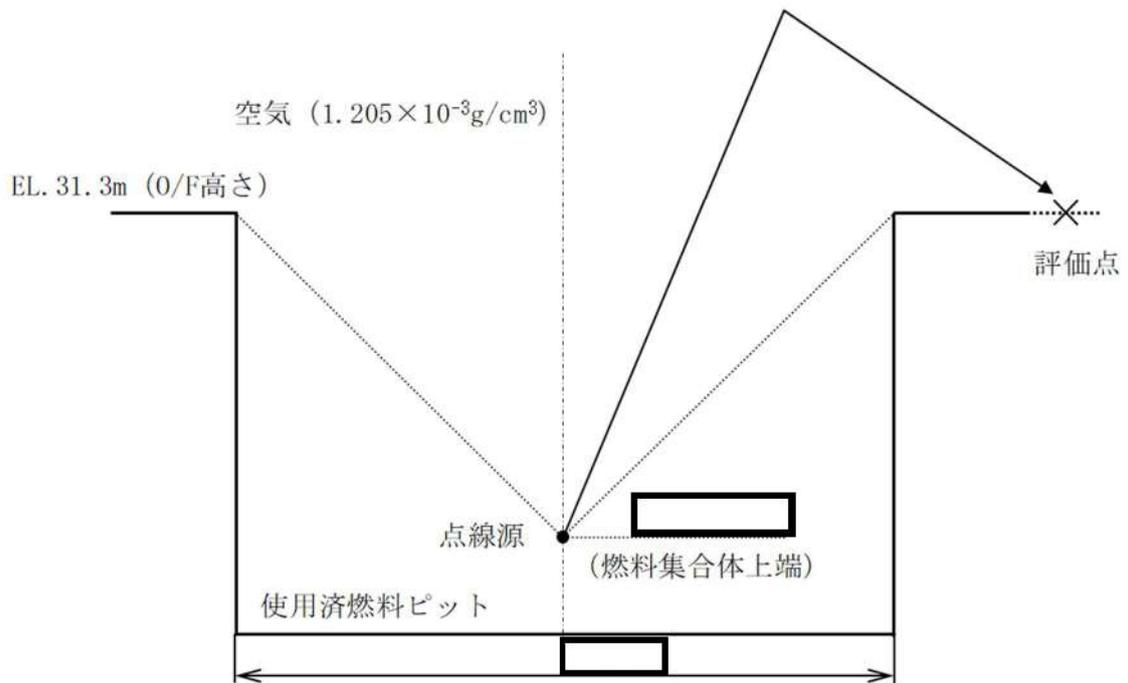
図1 スカイシャイン線量の評価モデル
