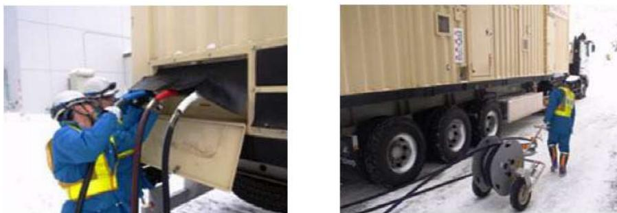
図2 可搬型代替電源車設置訓練
