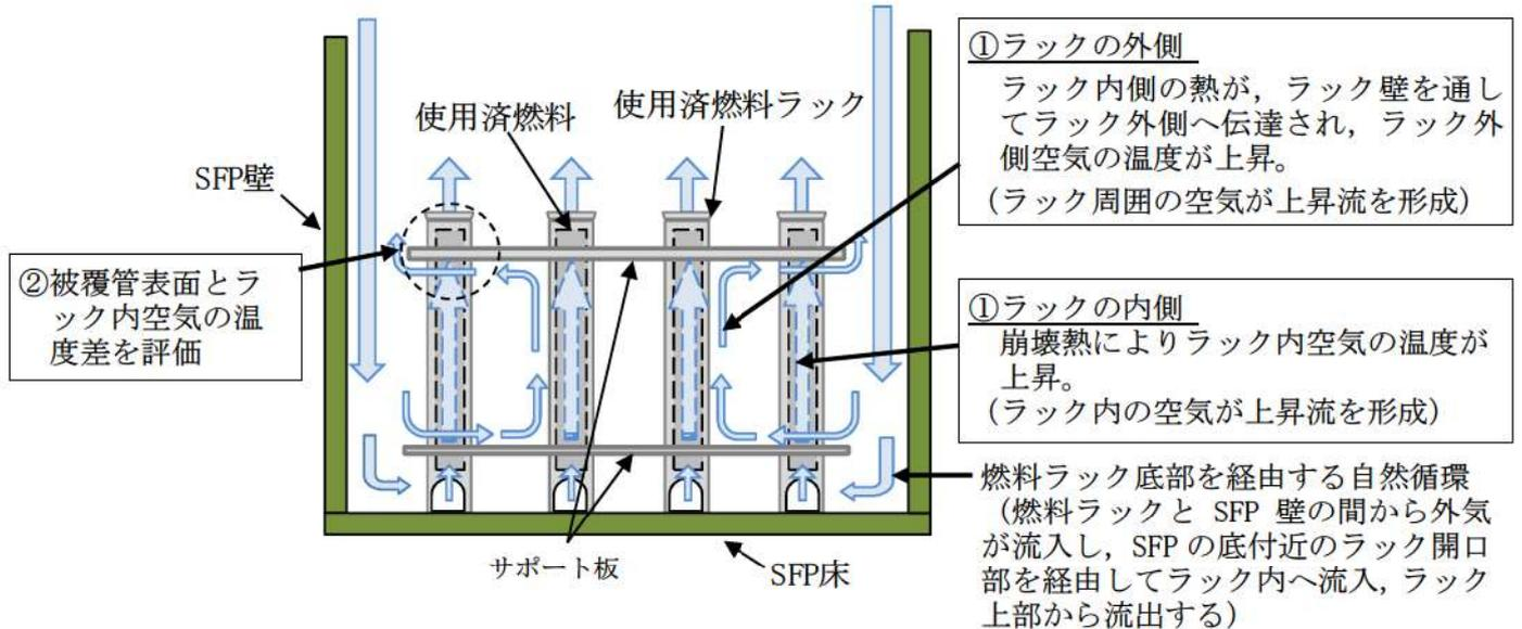
図1 燃料被覆管温度評価の概念図
