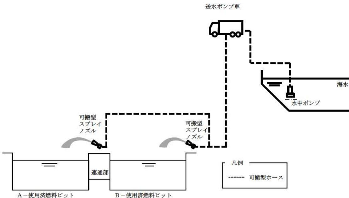
図2 海水を用いた送水ポンプ車及び可搬型スプレィノズル
