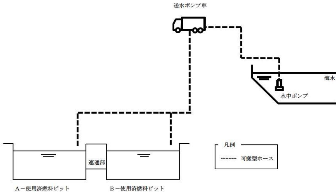
図1 海水を用いた送水ポンプ車による
