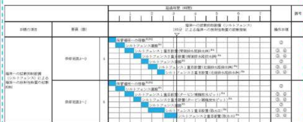
第1.12-9図 海洋への拡散抑制設備（シルトフェンス） タイムチャート
