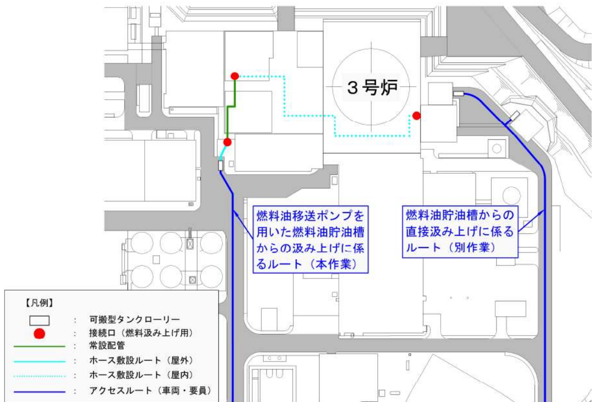
第7図 ディーゼル発電機燃料油移送ポンプ及び可搬型タンクローリーを用いた燃料補給のルート概略図
