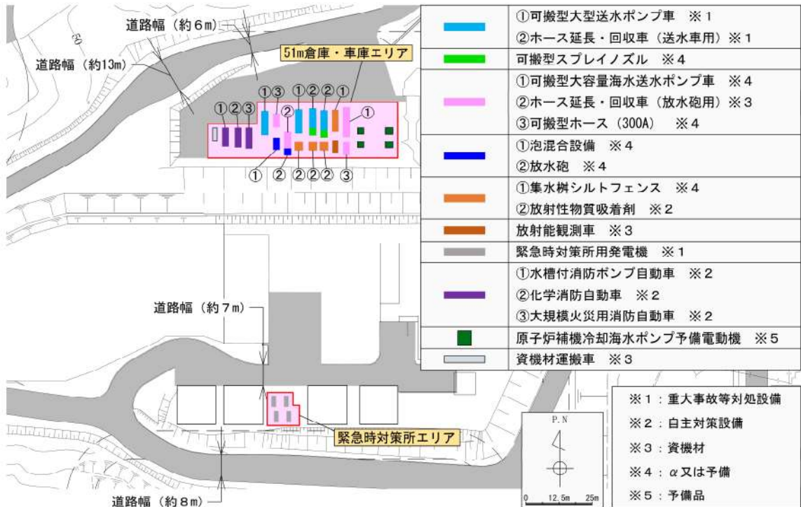
第2図 保管場所の可搬型設備配置(1/3)
