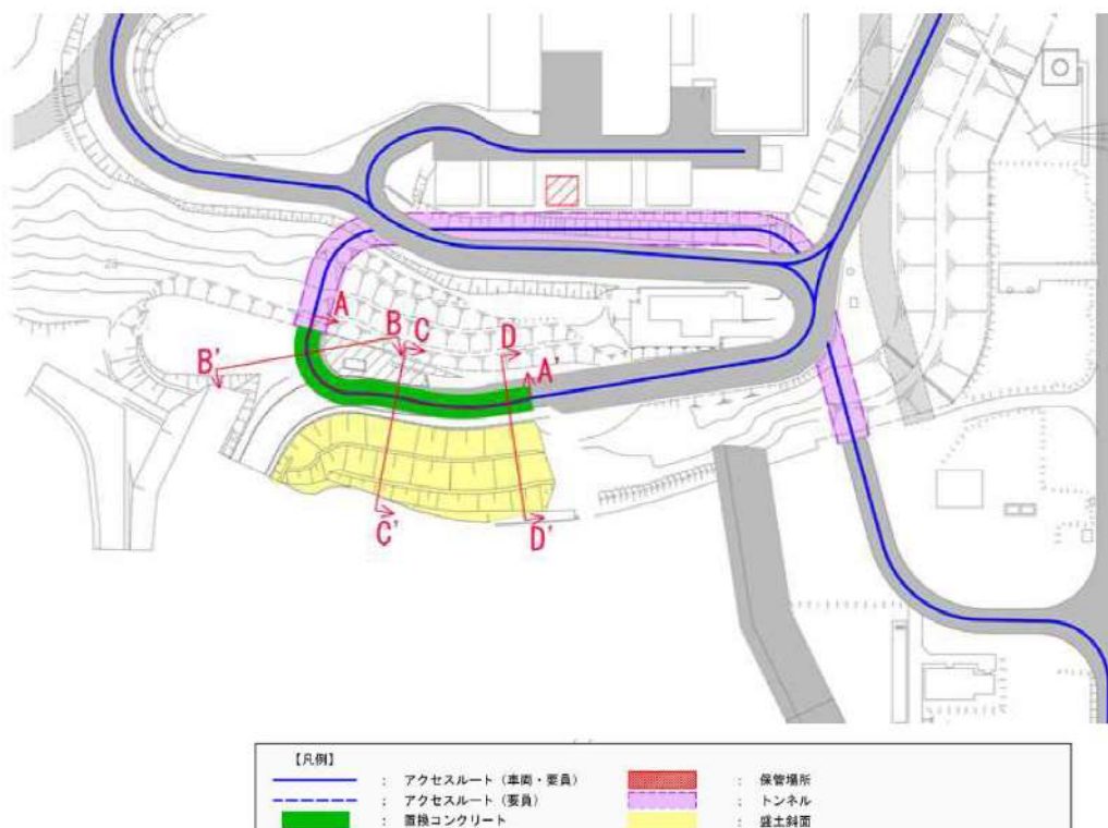
第 8.2-1 図 置換コンクリート範囲図
