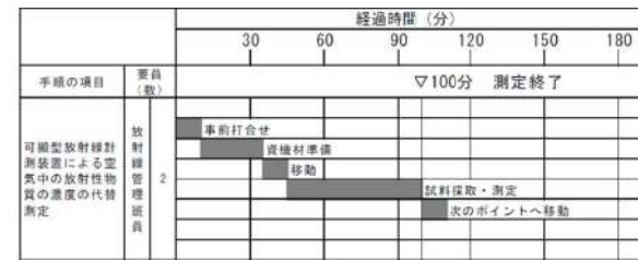
第 1.17-8 図 可搬型放射線計測装置による空気中の放射性物質の濃度の代替測定のタイムチャート
