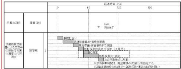
第 1.17.8 図 放射能測定装置による空気中の放射性物質の濃度の代替測定 タイムチャート
