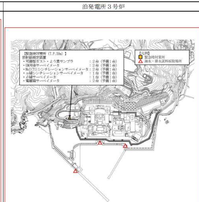
第 1.17.7 図 放射能測定装置の保管場所及び海水・排水試料採取場所
