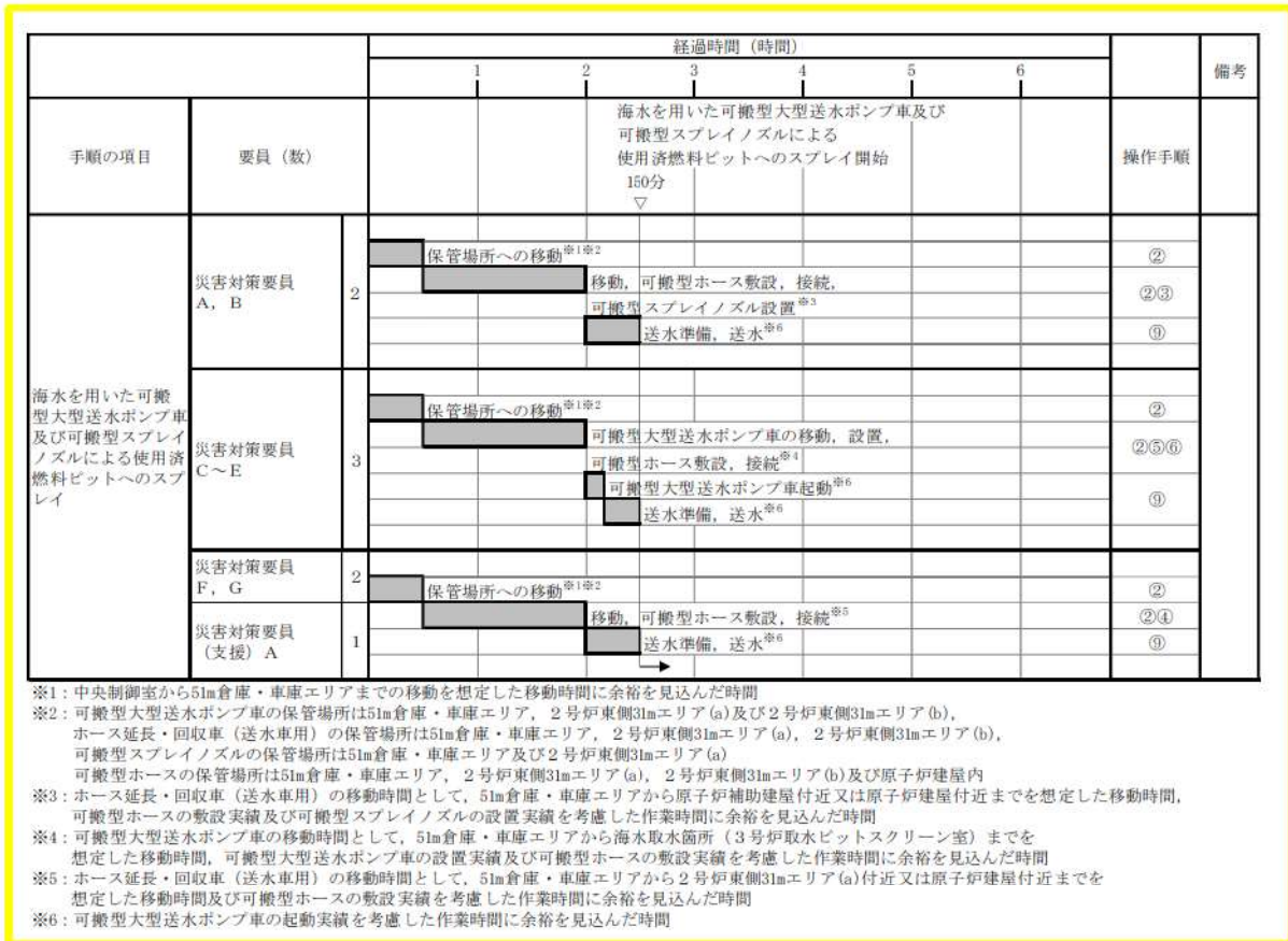
図2.12-6 海水を用いた可搬型大型送水ポンプ車及び可搬型スプレイノズルによる使用済燃料ピットへのスプレイ※
