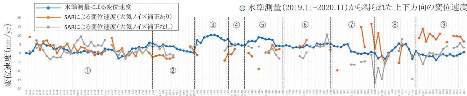
干渉SAR時系列解析と水準測量の比較(左:水準測量結果なし、右:水準測量結果あり)
