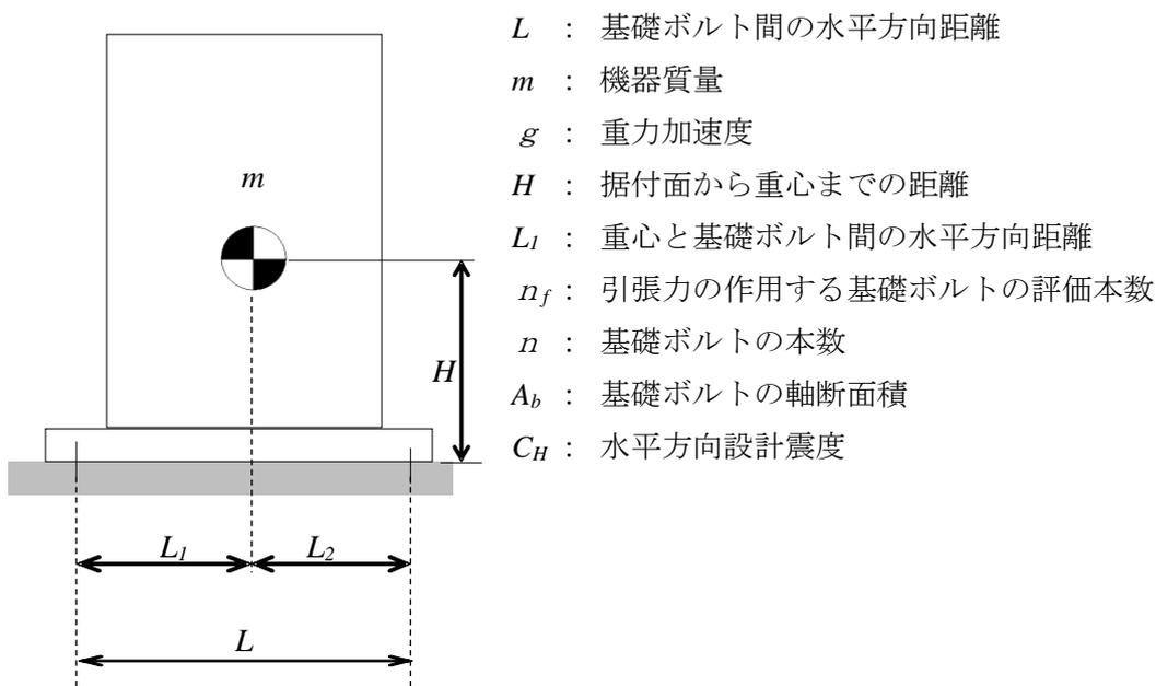
$$\text{基礎ボルトに作用する引張力} : F_b = \frac{1}{L} (m \times g \times C_H \times H - m \times g \times L_1)$$
