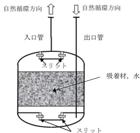
図－1 使用済吸着塔 保管時の概念図
