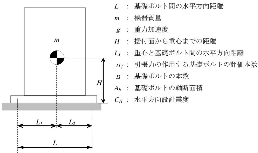
$$\text{基礎ボルトに作用する引張力} : F_b = \frac{I}{L} (m \times g \times C_H \times H - m \times g \times L_1)$$
