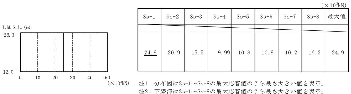
図4-4 最大応答せん断力 (基準地震動 S<sub>s</sub>, NS 方向)
