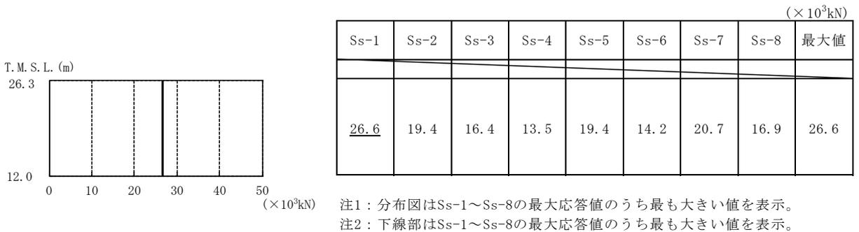
図4-8 最大応答せん断力（基準地震動S<sub>s</sub>，EW方向）
