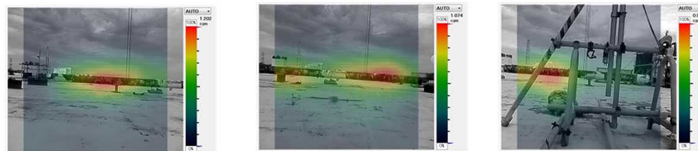
ガンマカメラ測定結果 (配管から4m離れた位置)
