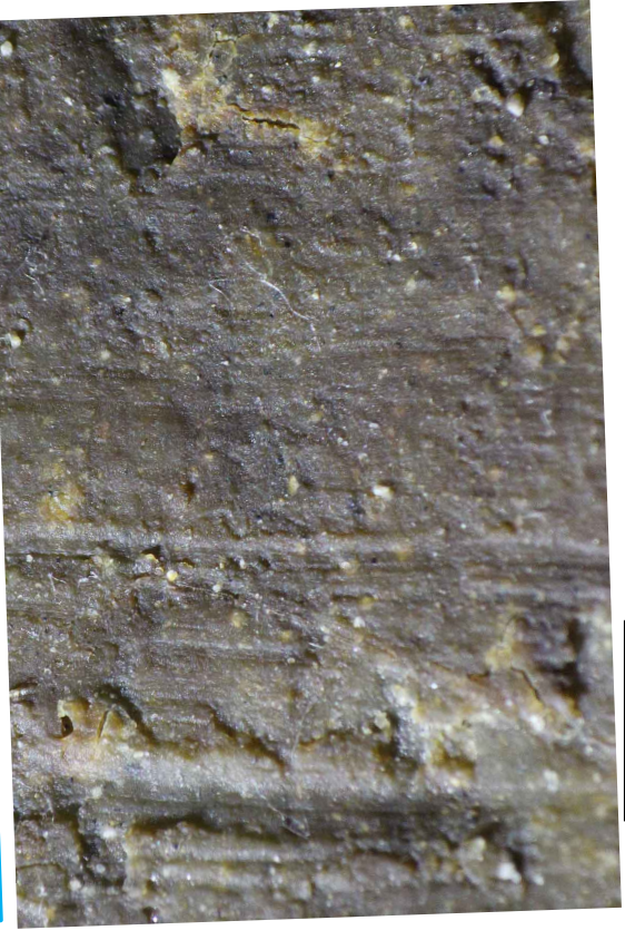
図(6.8) シームS-11の最新面の条線方向(Ts-6-B5-1ブロック試料)
