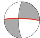
走向 = $272^\circ$<br>すべり角 = $-164^\circ$<br>傾斜角 = $83^\circ$ |
