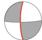
走向 = $180^\circ$<br>すべり角 = $-174^\circ$<br>傾斜角 = $78^\circ$ |
