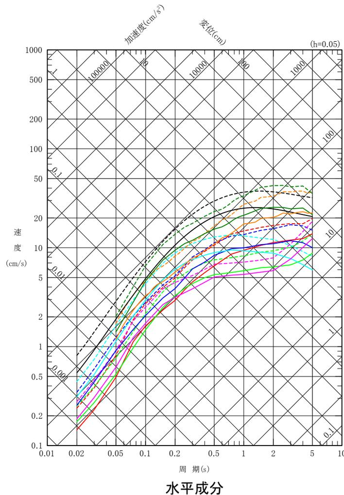
実線: 基本ケース, 短周期レベルの不確かさケース, 破壊伝播速度の不確かさケース(Mw7.7, 断層最短距離70km)
