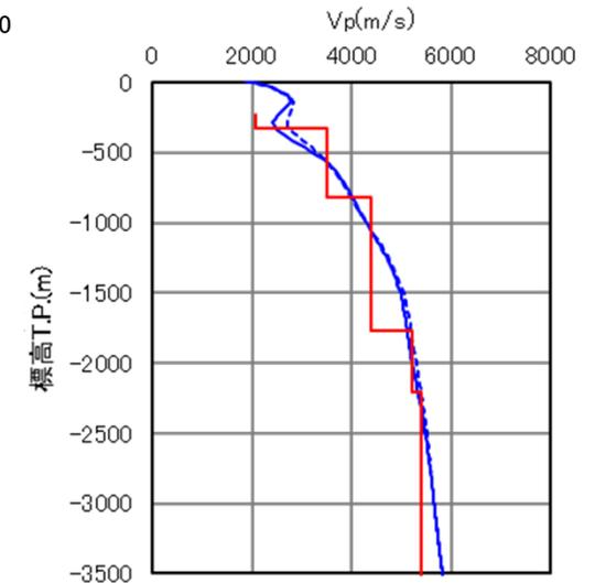
フルウェーブインバージョン解析(FWI)結果と「理論的手法に用いる深部地下構造モデル」の比較
