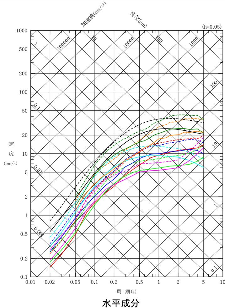
地震動評価に用いた距離減衰式は水平成分のみを評価対象としており, 鉛直成分は適用対象外。
