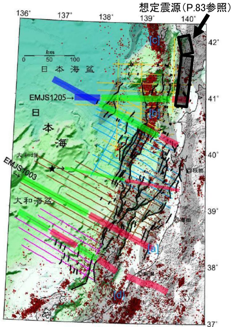
ひずみ集中帯の重点的調査観測・研究プロジェクト(2013)による地殻の分類
