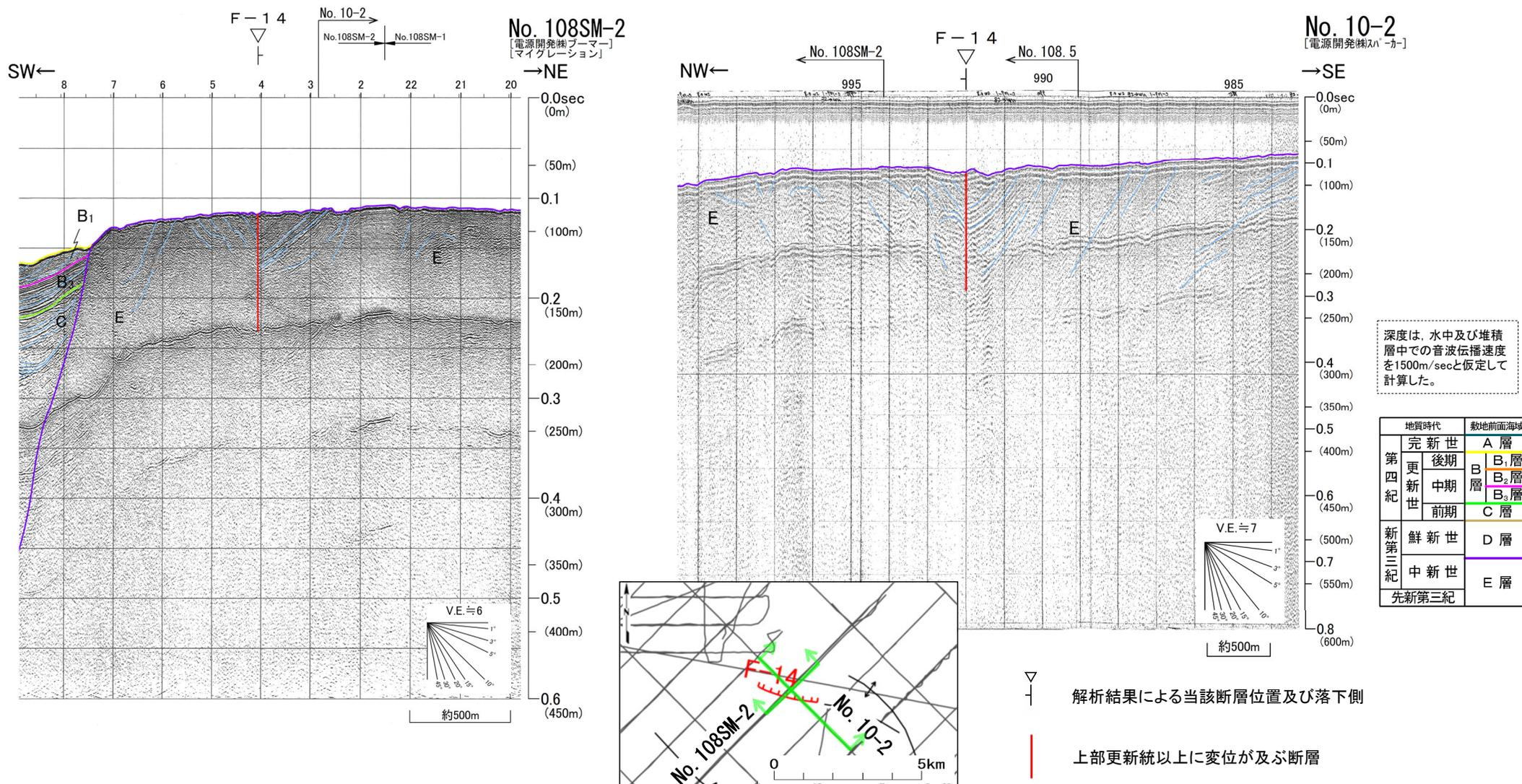
深度は、水中及び堆積層中での音波伝播速度を1500m/secと仮定して計算した。
