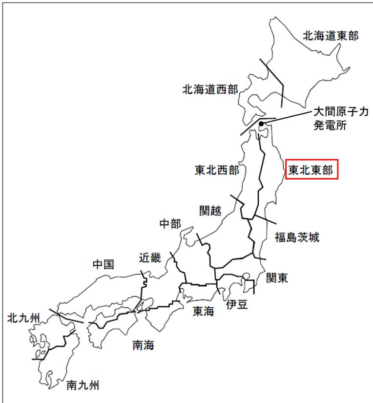
原子力安全基盤機構(2004)による地震域の区分
