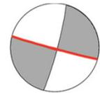
走向 = $105^\circ$<br>すべり角 = $-175^\circ$<br>傾斜角 = $88^\circ$   |
