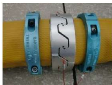
可搬型ホース(150A)接続後
