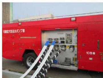
可搬型大型送水ポンプ車 周辺のホース敷設 （屋外）
