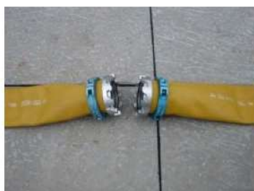
可搬型ホース(150A)接続前
