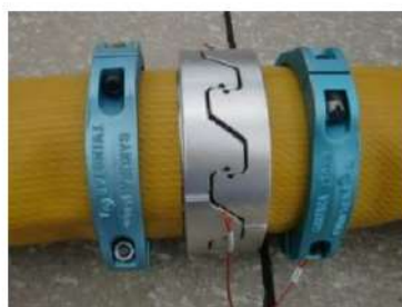
可搬型ホース(150A)接続後
