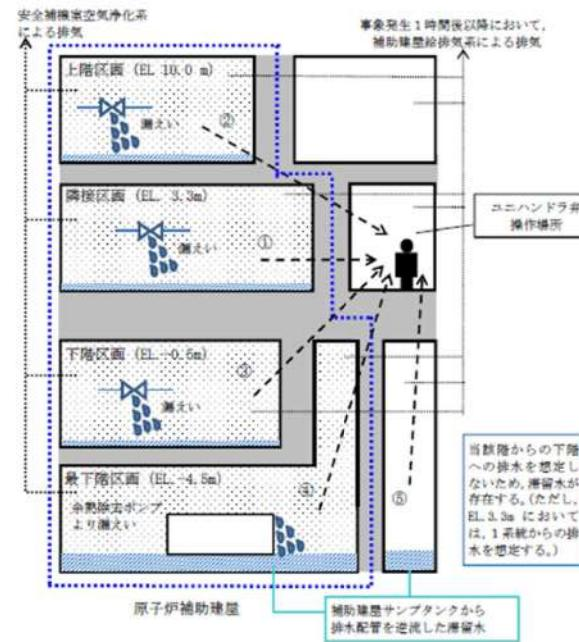
第2図 ユニハンドラ弁操作場所 断面イメージ図
