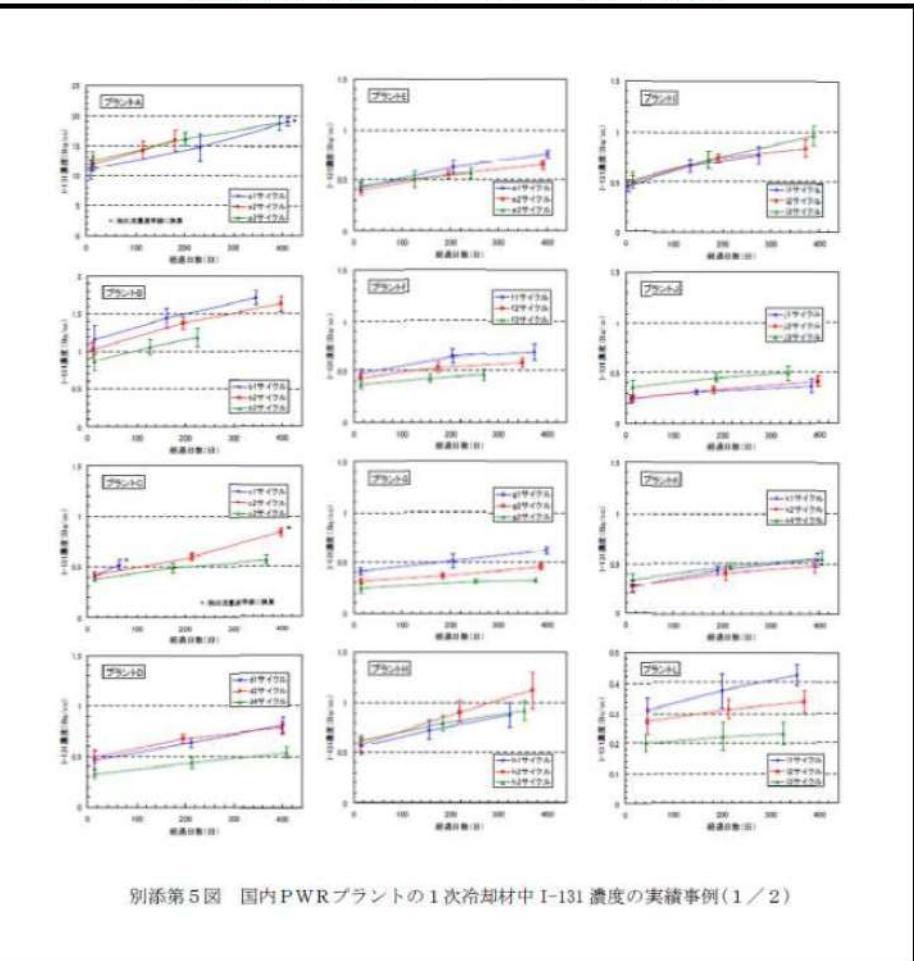
別添第5図 国内PWRプラントの1次冷却材中 I-131 濃度の実績事例(1 / 2)
