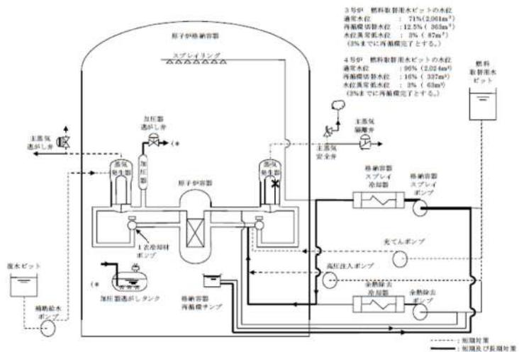
図2 蒸気発生器伝熱管破損+破損側蒸気発生器の隔離失敗概略図（余熱除去運転失敗時）
