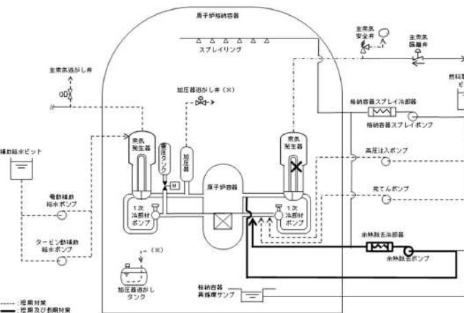
図1 蒸気発生器伝熱管破損+破損側蒸気発生器の隔離失敗概要図（余熱除去運転時）
