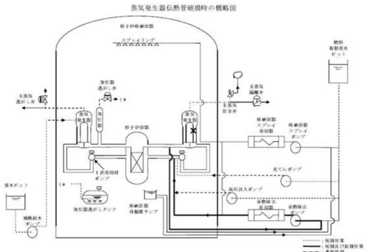
図1 蒸気発生器伝熱管破損+破損側蒸気発生器の隔離失敗概略図（余熱除去運転時）
