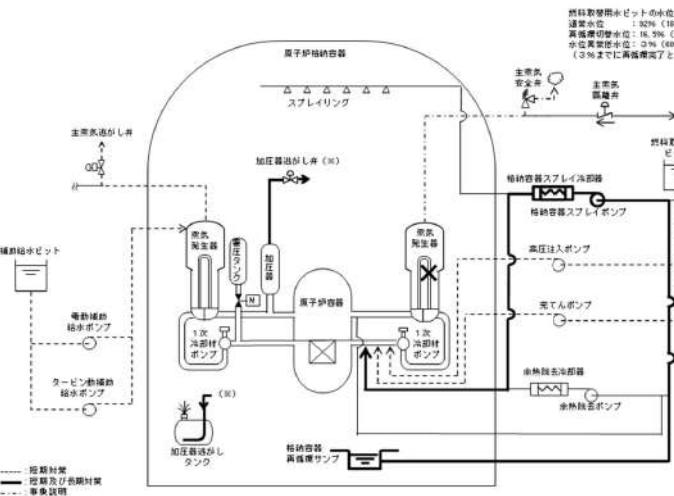
図2 蒸気発生器伝熱管破損+破損側蒸気発生器の隔離失敗概要図（余熱除去運転失敗時）
