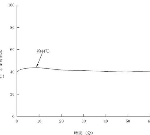
図4 階段室の雰囲気温度
